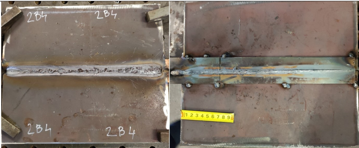
Slika 14. Uzorak U1 - zavar odozgo (desno), - korijen zavora odozdo (lijevo)
