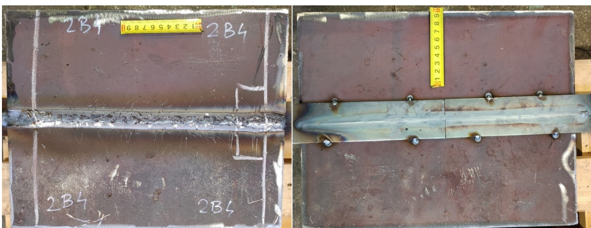
Slika 12. Uzorak U3 - zavar odozgo (desno), - korijen zavora odozdo (lijevo)
