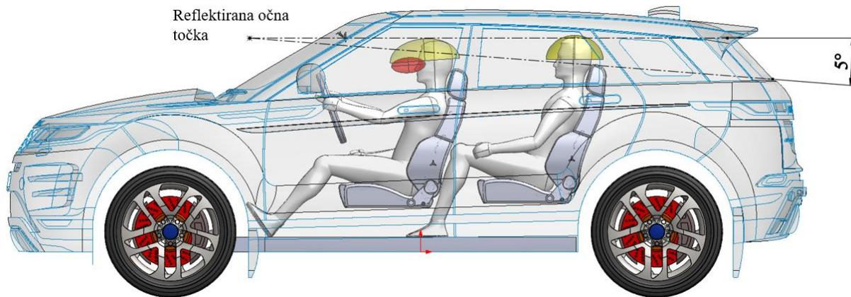
**Slika 45. Stražnji kut vidljivosti u uzdužno vertikalnoj ravnini**
