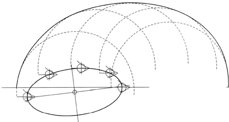
**Slika 6. Definiranje konture glave pomoću očnog elipsoida [6]**
