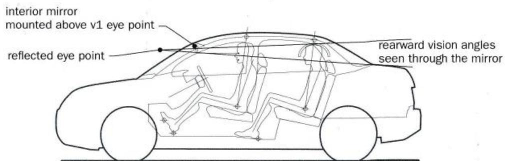
**Slika 22. Stražnji kut vidljivosti u uzdužno vertikalnoj ravnini [2]**
