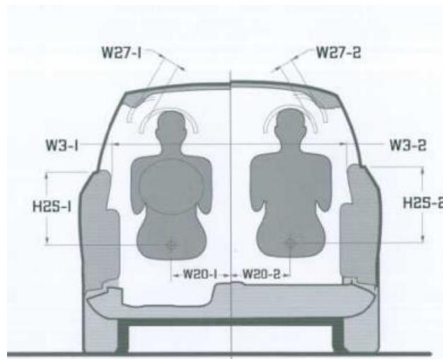
**Slika 15. Dimenzijski presjek putničkog prostora u poprečnom presjeku C-C [2]**
