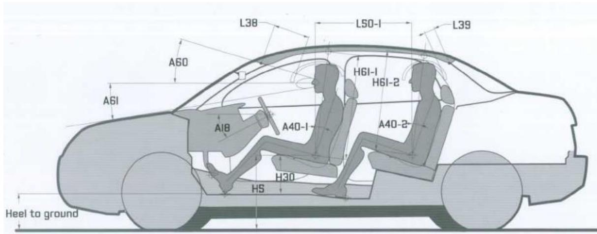
**Slika 14. Dimenzijski presjek putničkog prostora u poprečnom presjeku A-A [2]**
