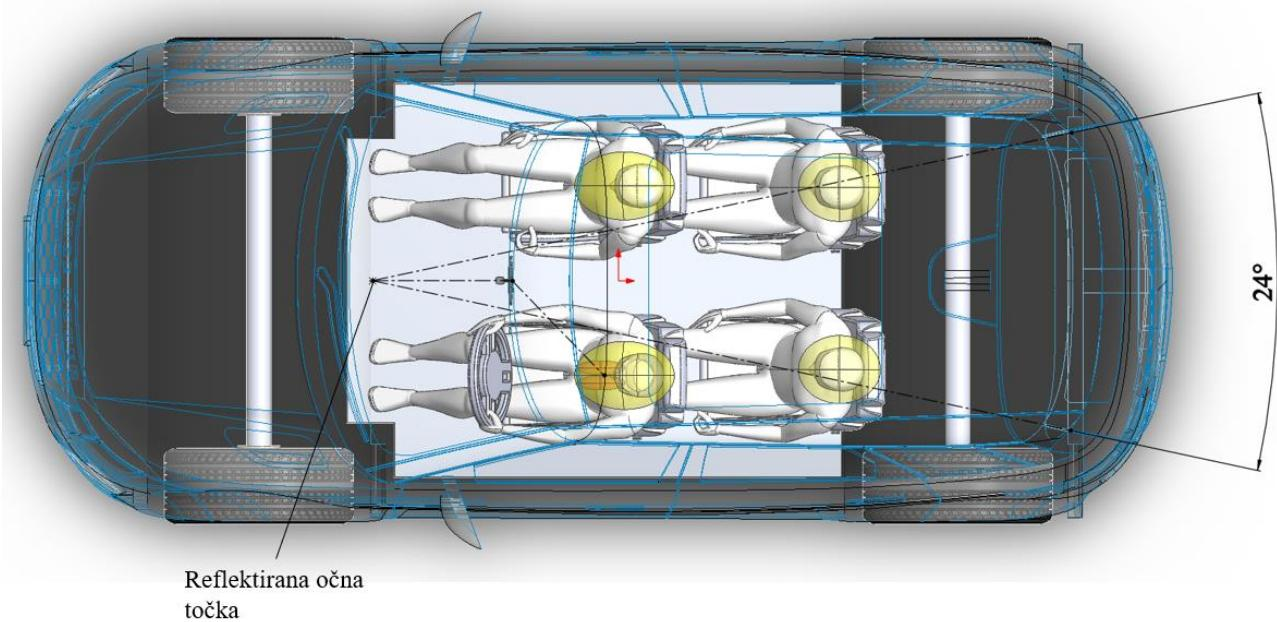
**Slika 46. Stražnji kut vidljivosti u uzdužno poprečnoj ravnini**
