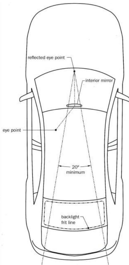
**Slika 23. Stražnji kut vidljivosti u uzdužno poprečnoj ravnini [2]**
