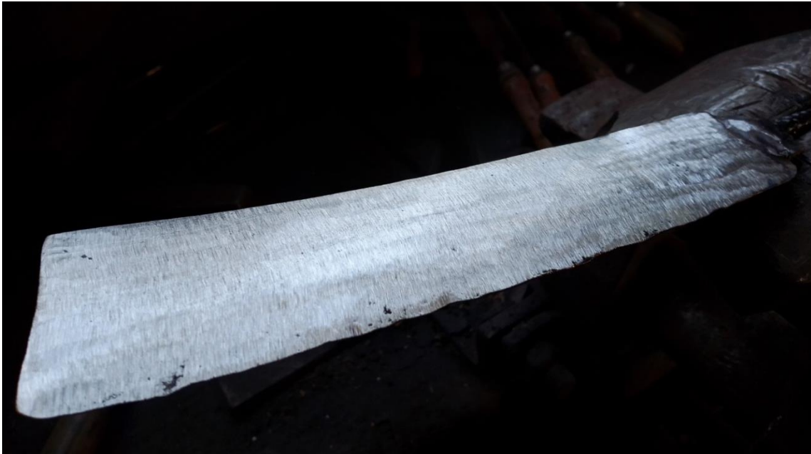
Slika 32. Mačeta nakon finog brušenja
