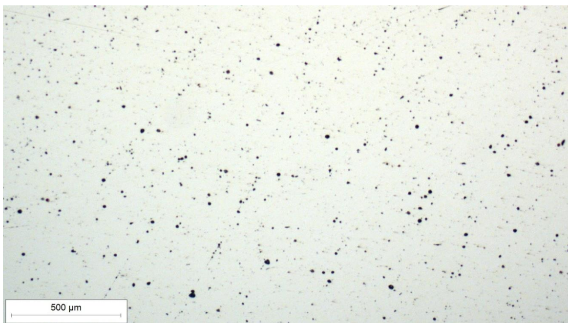
Slika 43. Mikrostruktura poprečnog presjeka mačete nasuprot oštrici, snimljeno pri povećanju 50×
