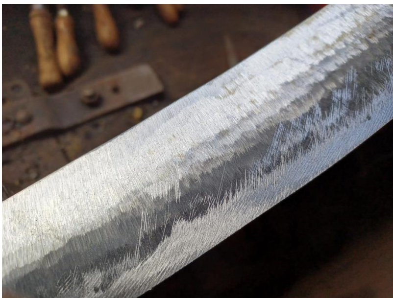
Slika 36. Oštrica mačete nakon oštrenja turpijom
