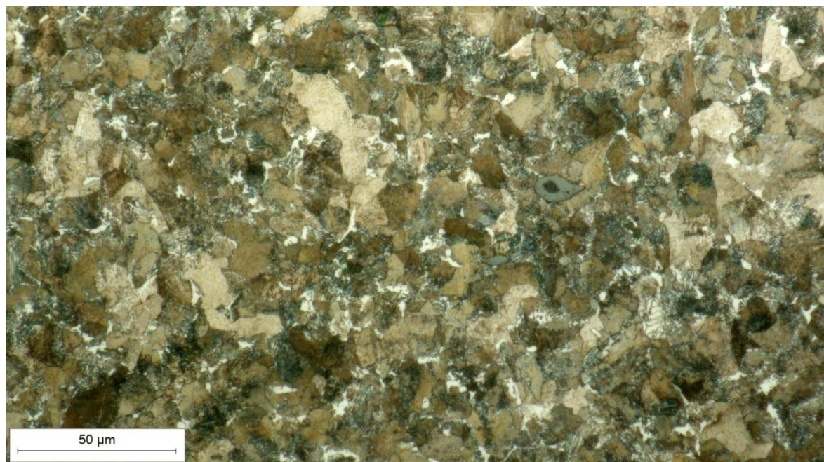
Slika 51. Mikrostruktura mačete u sredini poprečnog presjeka, snimljeno pri povećanju 500×
