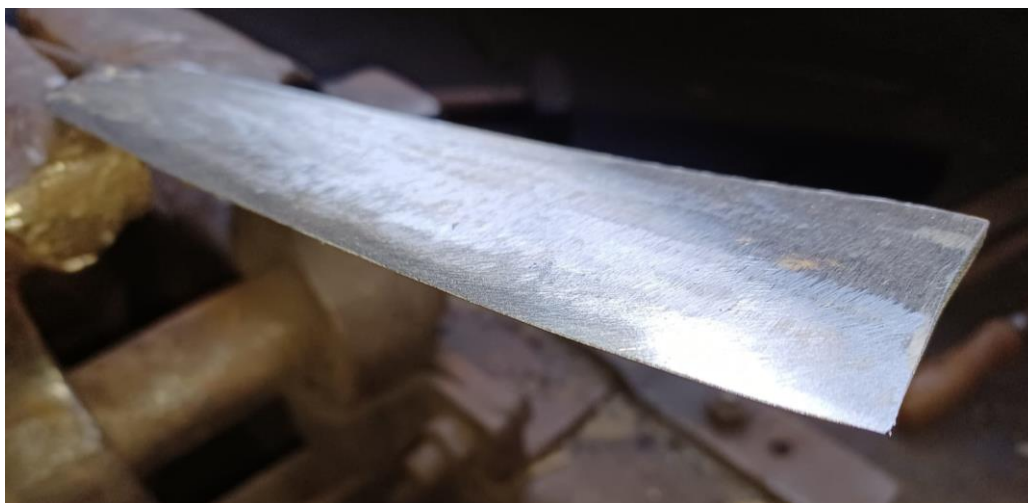
Slika 37. Oštrica mačete nakon završnog oštrenja brusnim papirom
