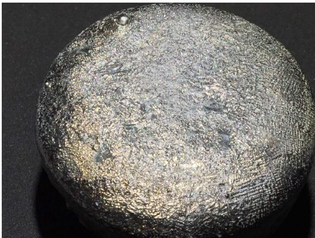
Slika 8. Odljevak wootz čelika[10]
