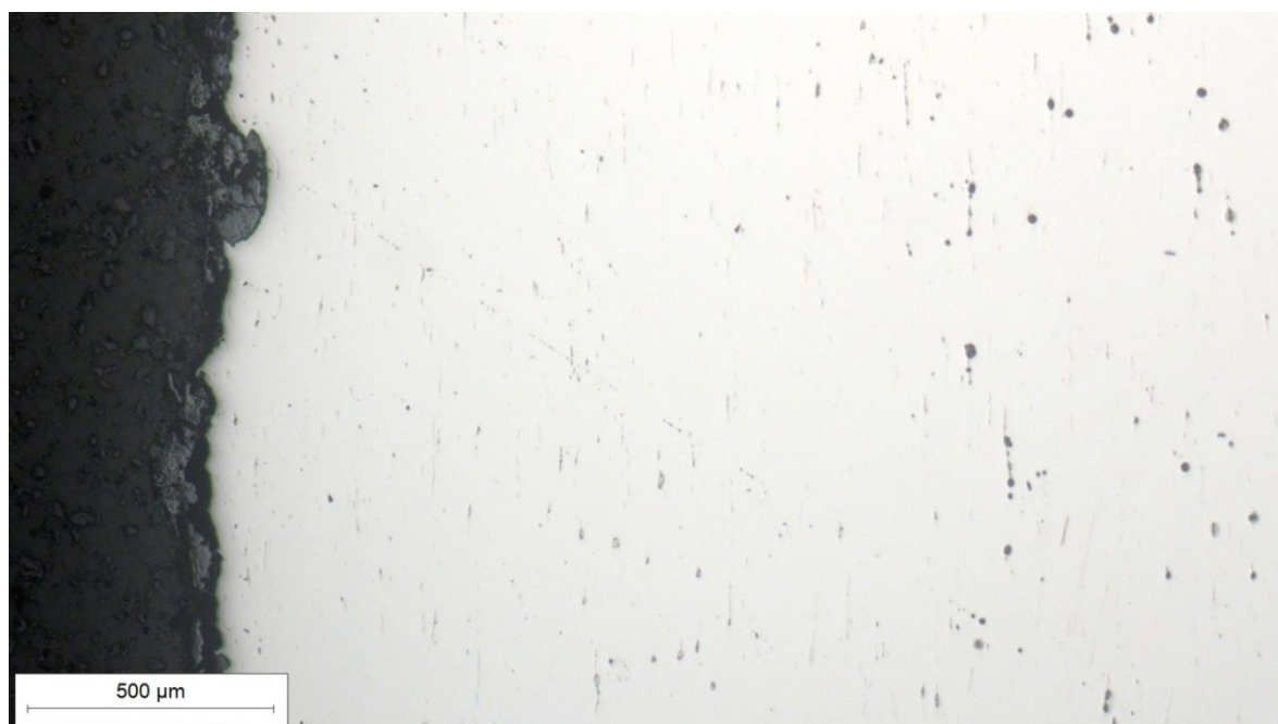
Slika 41. Mikrostruktura osnovnog materijala prije kovanja u poliranom stanju (lijevi rub) snimljena pri povećanju 50×
