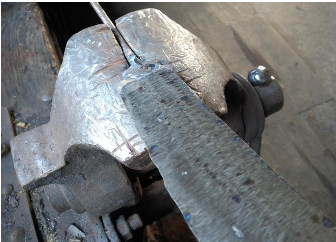
Slika 30. Mačeta nakon grubog brušenja
