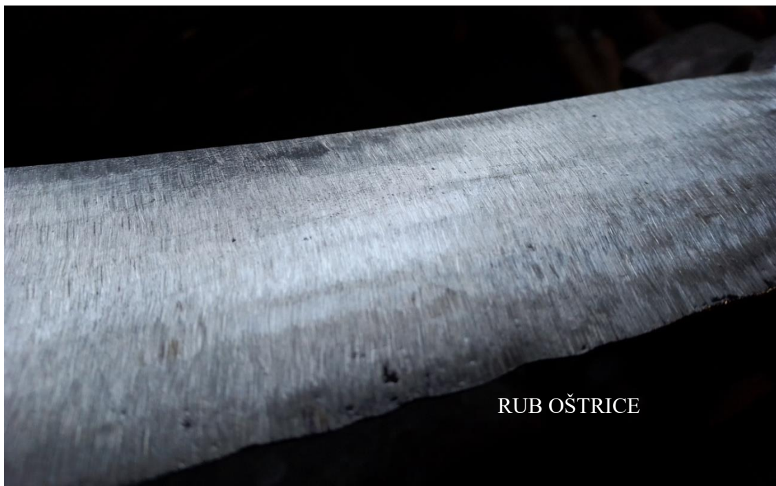
Slika 33. Površina mačete nakon finog brušenja
