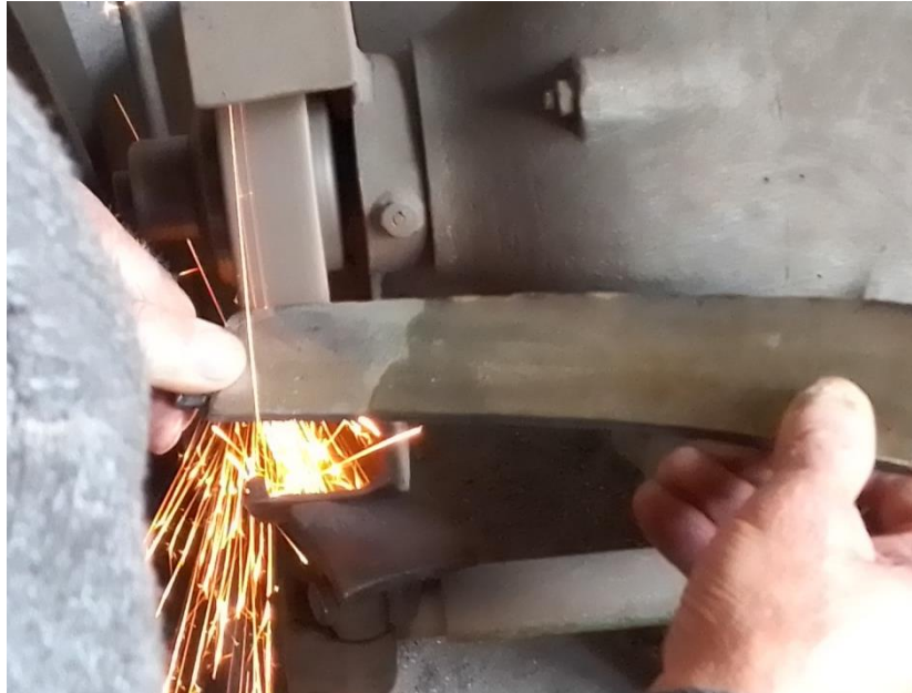
Slika 34. Poravnanje oštrice mačete na stolnoj brusilici
