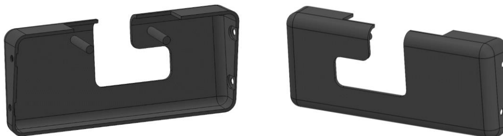
Slika 60. Prikaz poklopca za zaštitu od oštećenja u zadnjem (lijevo) i prednjem (desno) pogledu
