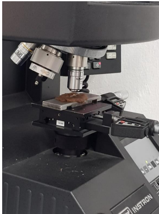
Slika 41. Ispitivanje površinske tvrdoće
