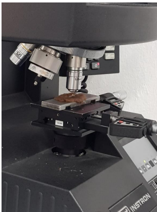
Slika 41. Ispitivanje površinske tvrdoće
