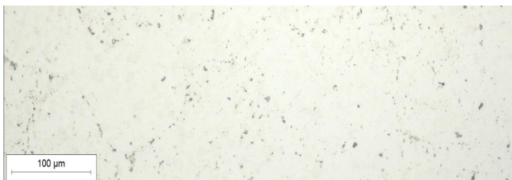
Slika 34. Jezgra boriranog čelika X90CrMoV18
