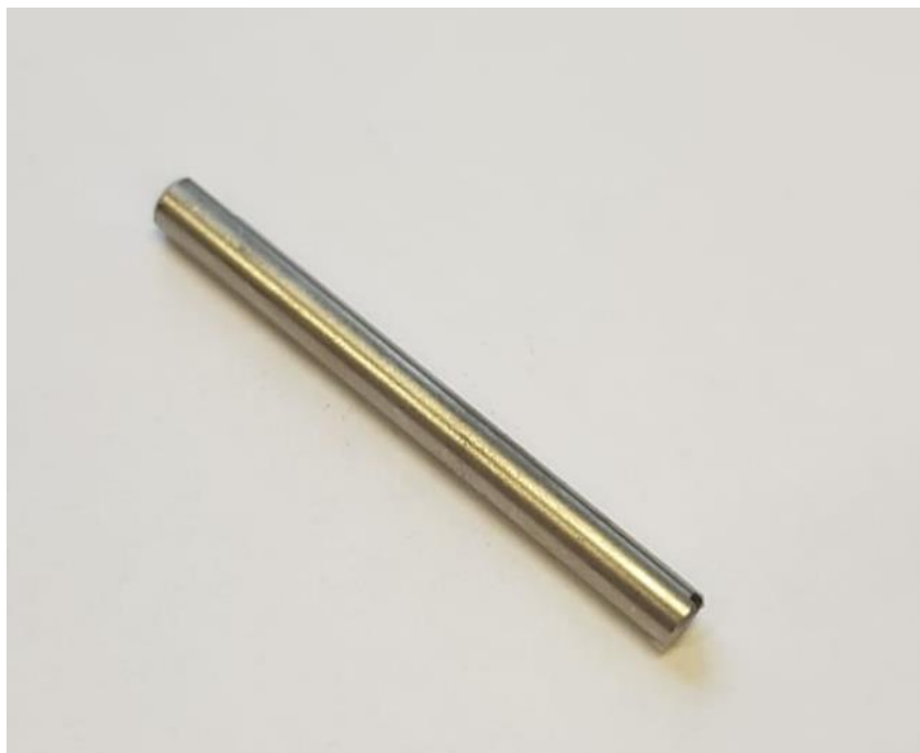
Slika 24. Uzorak od čelika X90CrMoV18 prije boriranja
