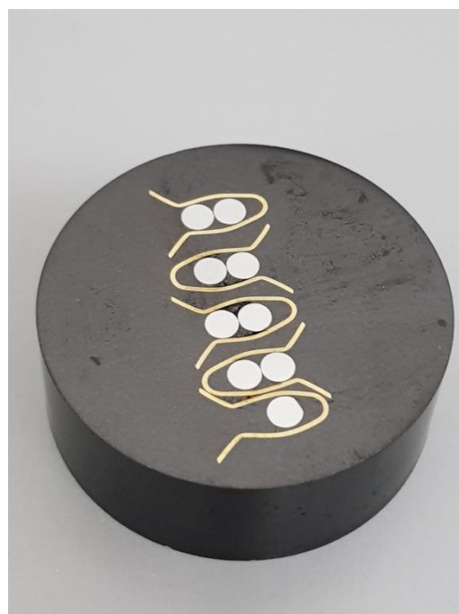
Slika 29. Uzorci u polimernoj masi
