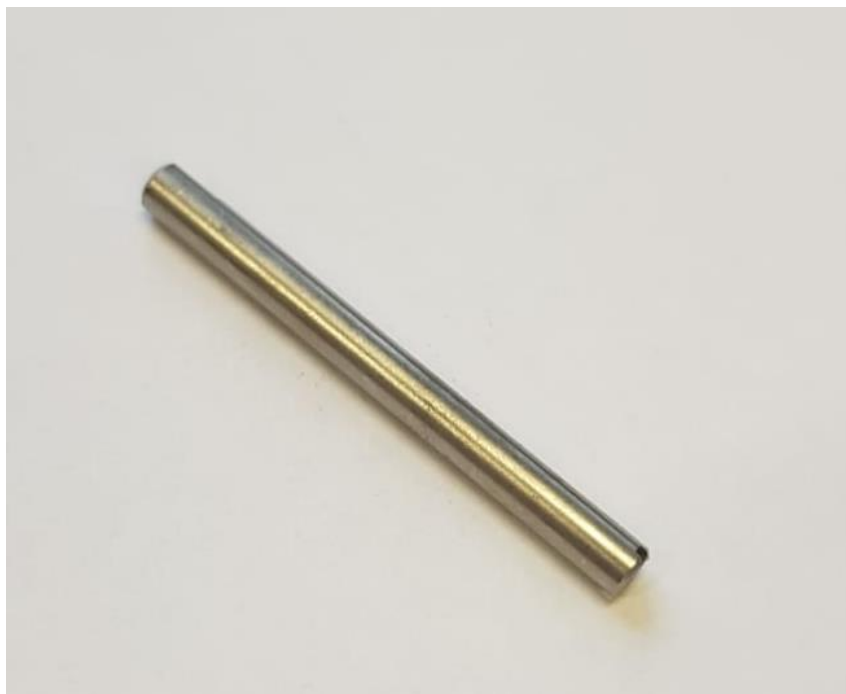
Slika 24. Uzorak od čelika X90CrMoV18 prije boriranja
