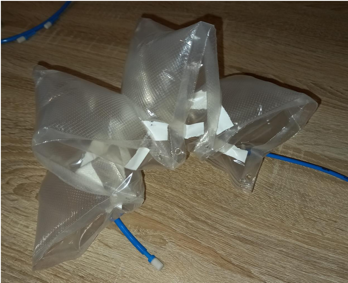
Slika 27. Napuhani fleksibilni pneumatski aktuator (2)
