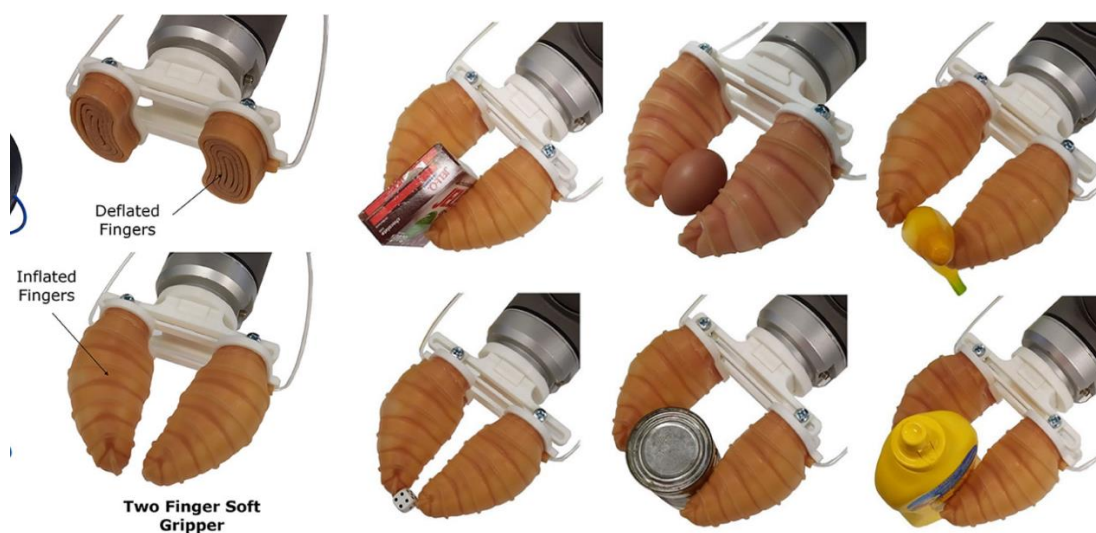
Slika 5. Fleksibilna hvataljka za hvatanje objekata raznih veličina i oblika [5]
