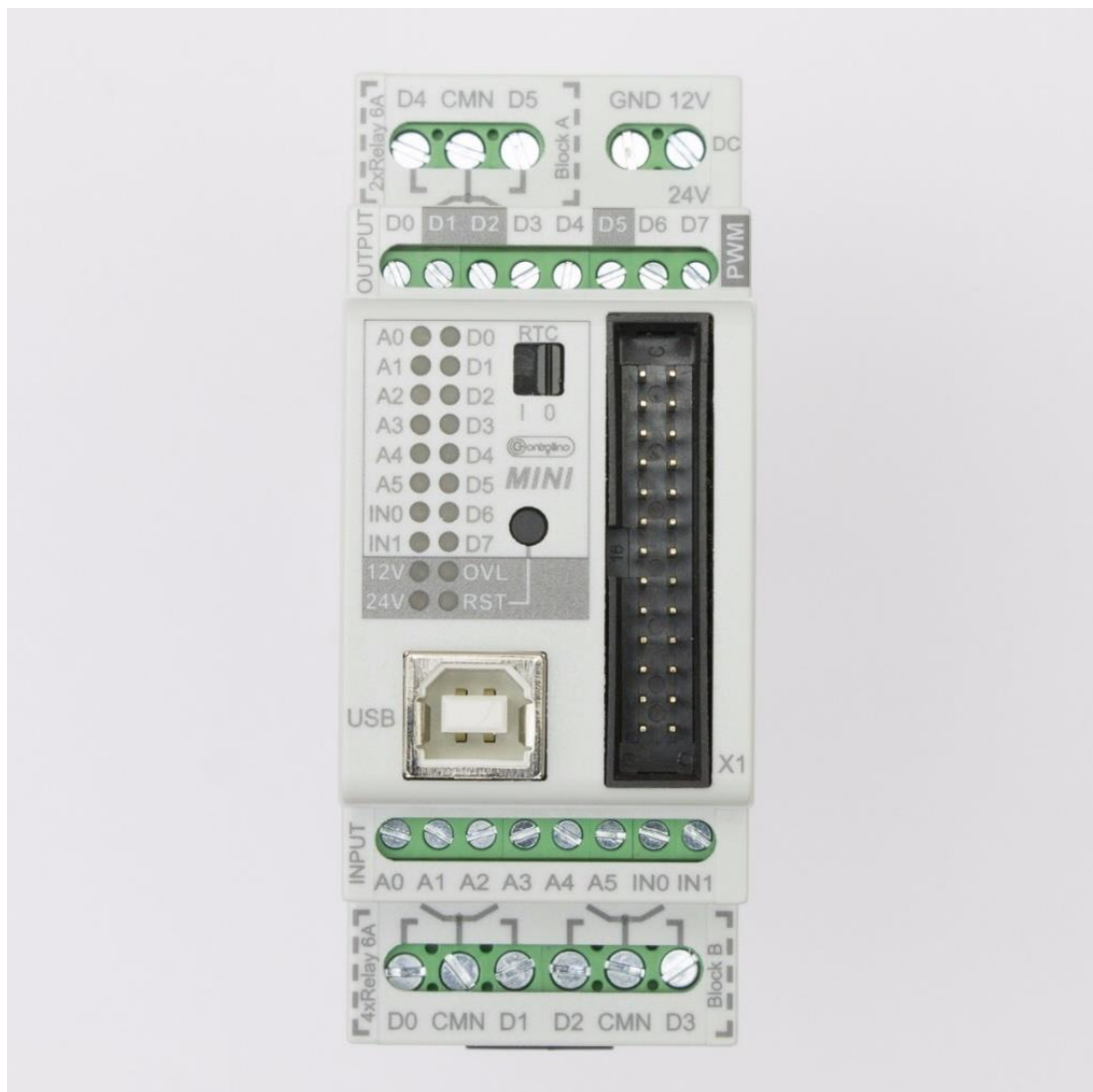
Slika 19. Priključci na Controllinu mini [15]
