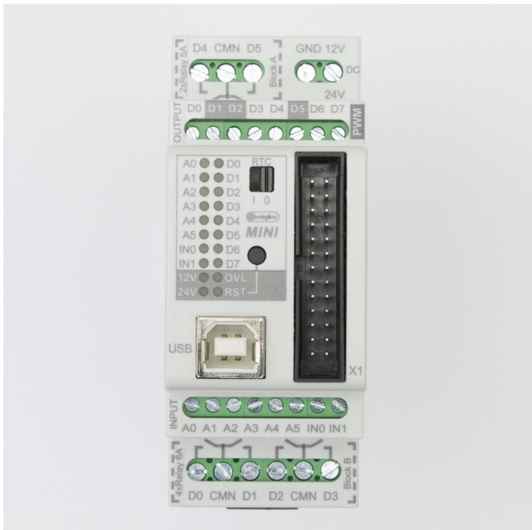
Slika 19. Priključci na Controllinu mini [15]
