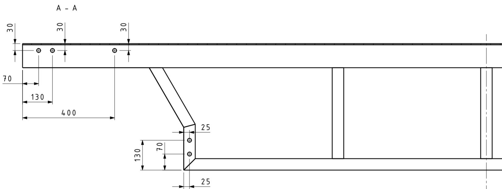
Napomena: Provri te bušiti nakon zavarivanja, skroz kroz profil i ploču.
