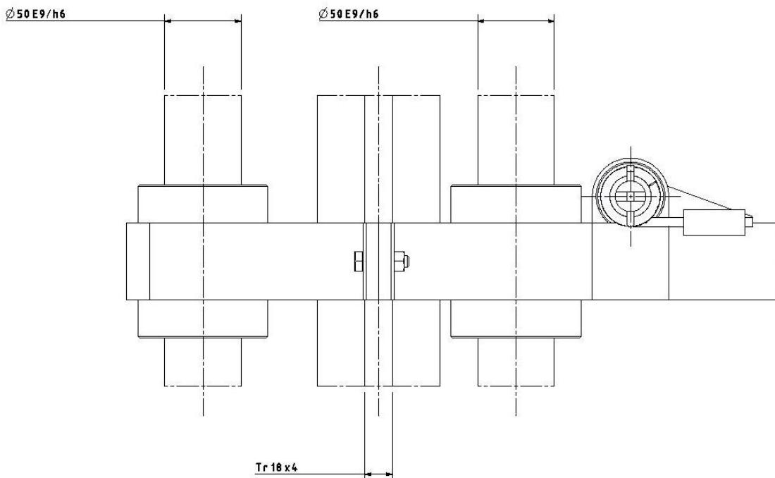
Slika 19. Prikaz montiranog zahvatnog mehanizma
