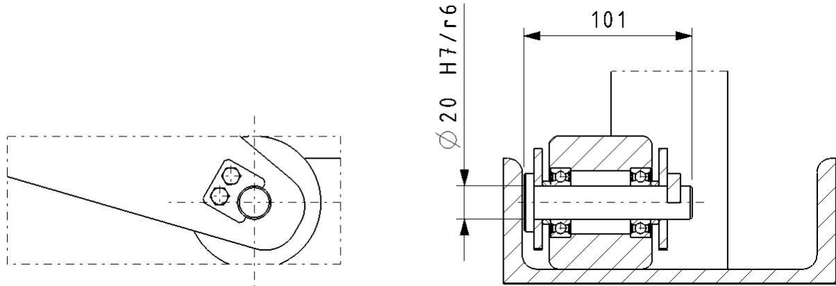
Slika 14. Prikaz montiranog kotača
