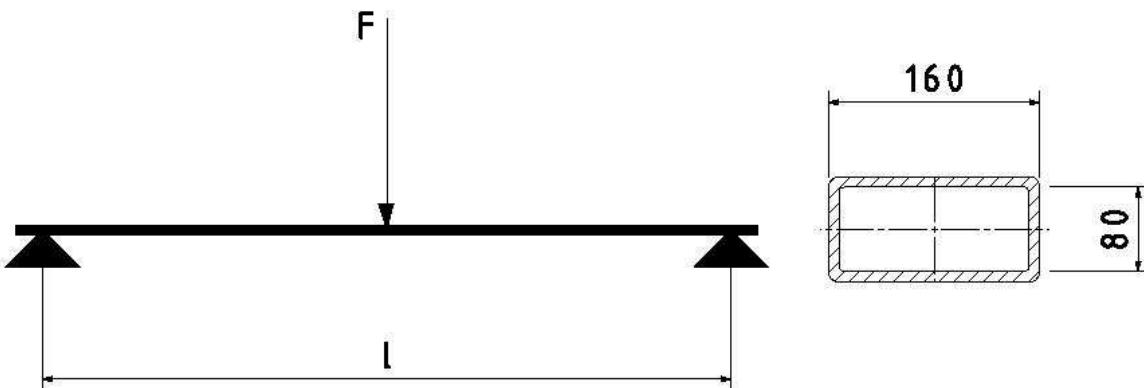
Slika 5. Prikaz opterećenja i presjeka profila 160x80x8
