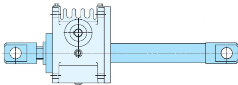
Slika 23. Reduktor s vretenom i prirubnom cijevi HSE 31
