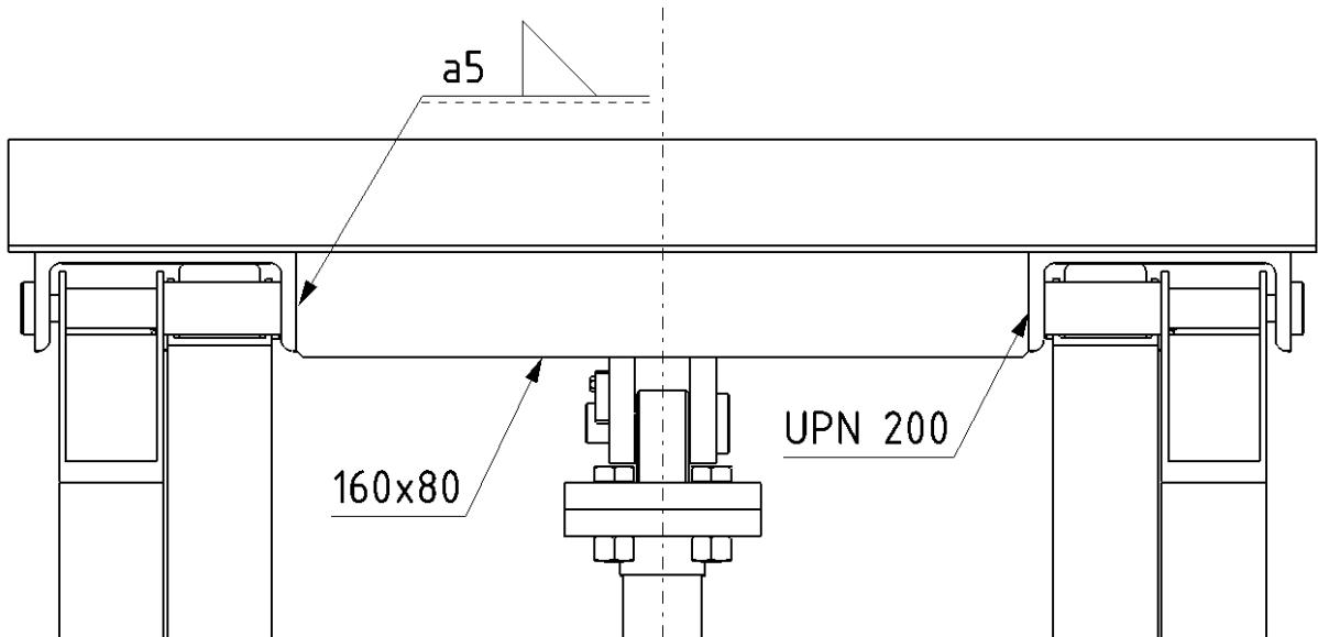
Slika 6. Prikaz pozicije zavara profila 160x80x8
