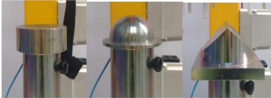
Slika 32. S lijeva na desno prikazan je ravni, polukupolasti te nakovanj u obliku rubnjaka [23]
