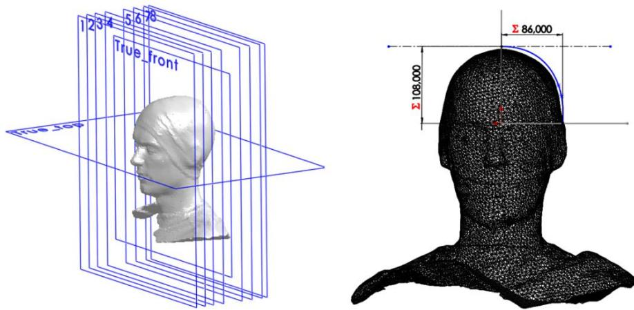
Slika 41. Referentne površine pri modeliranju
