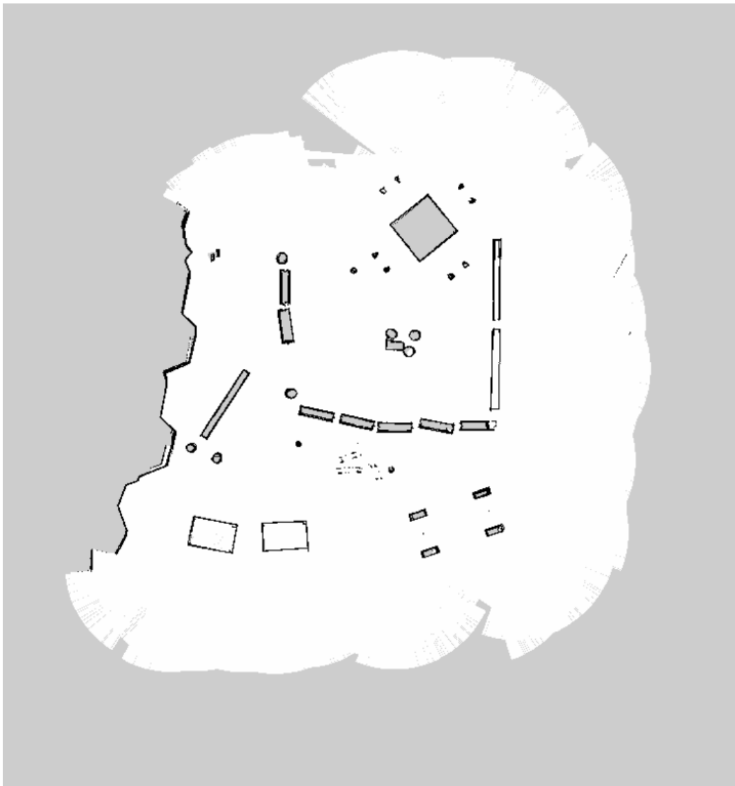
Slika 28. Generirana mapa virtualnog okruženja robota
