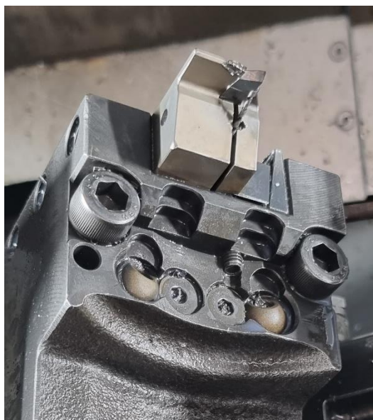
Slika 30. Alat za izradu GIP utora na obodu
