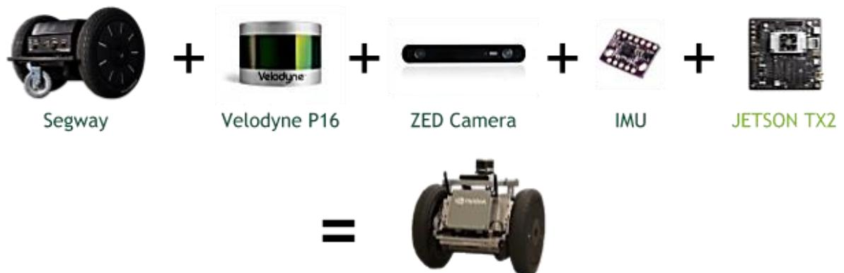
**Slika 12.** Komponente sustava mobilnog robota Carter. [16]
