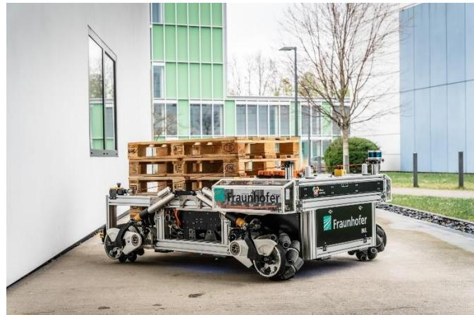
**Slika 7. Fraunhofer IML – autonomni robot za skladišta [20]**
