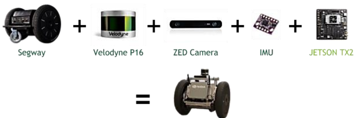
Slika 12. Komponente sustava mobilnog robota Carter. [16]
