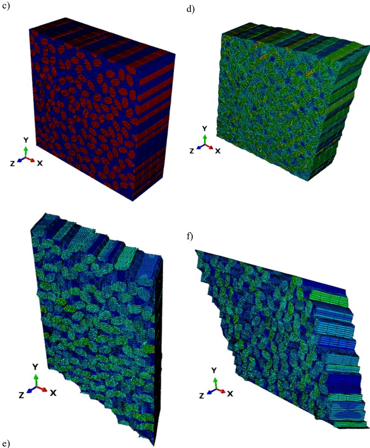
Slika 30. Naprezanja strukture 45 % udjela vlakana:
