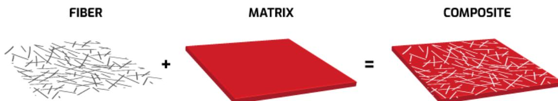
Slika 3. Nastanak kompozita ojačanog vlaknima [7]
