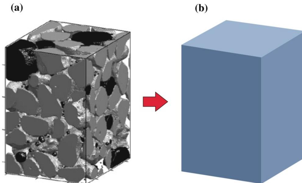
Slika 13. Princip homogenizacije [18]
