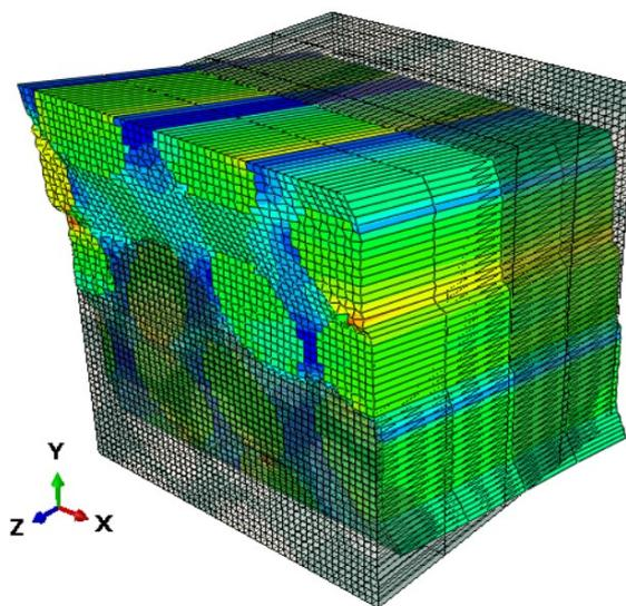
**Slika 26. Raspodjela posmičnih napreznja RVE-a veličine 25  $\mu\text{m}$  za slučaj čistog smika:
