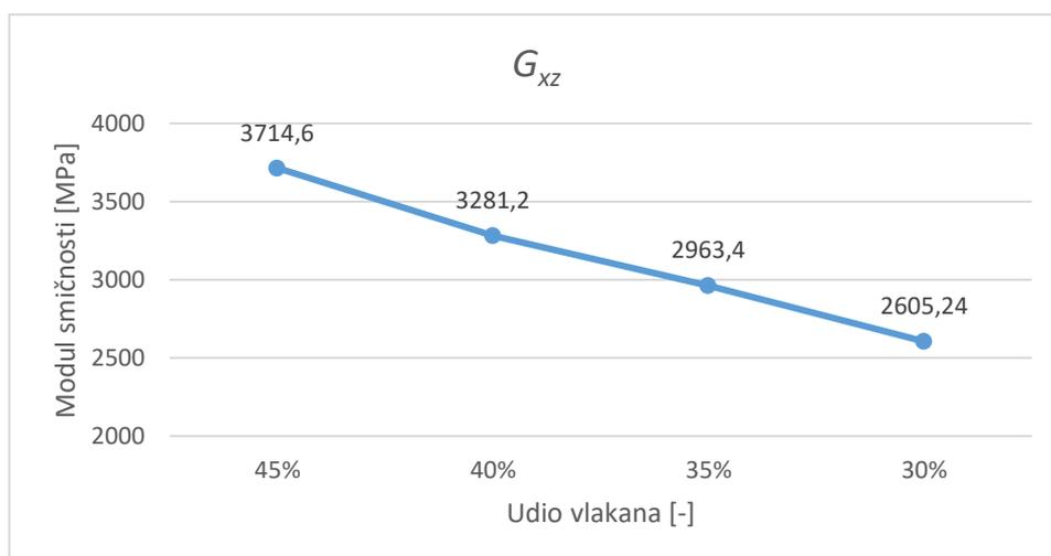
Slika 35. Moduli smičnosti u  $xz$  ravnini,  $G_{xz}$
