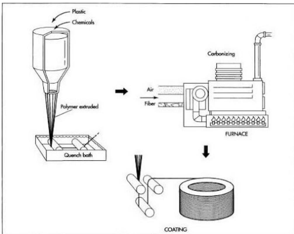
Slika 5. Postupak proizvodnje ugljičnih vlakana iz PAN-a [10]
