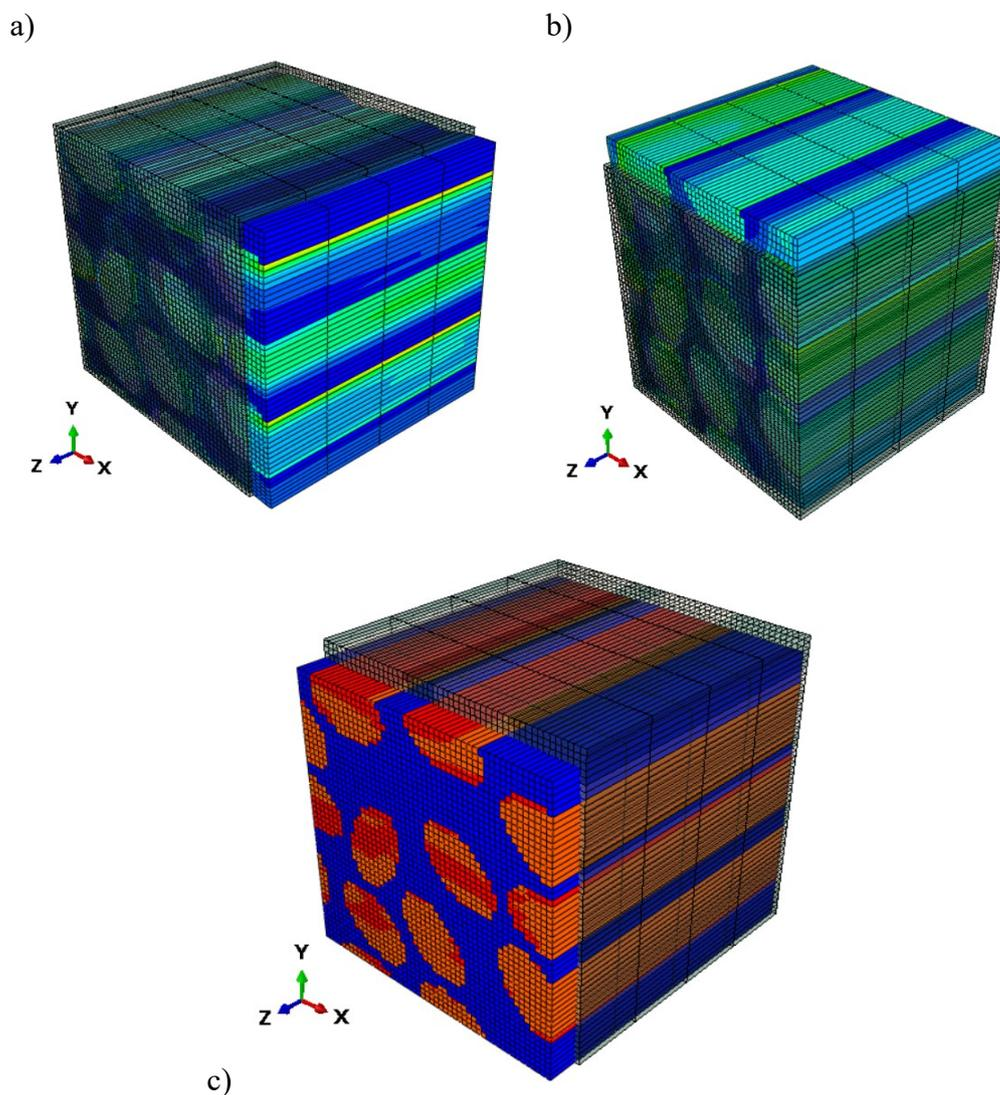
Slika 25. Raspodjela normalnih naprezanja RVE-a veličine 25  $\mu\text{m}$  za jednoosno istežanje:
