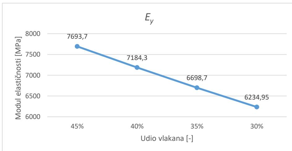
Slika 32. Moduli elastičnosti u smjeru osi  $y$ ,  $E_y$
