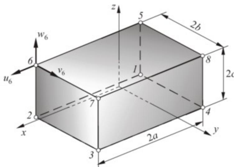
Slika 9. Osnovni prizmatični element [13]
