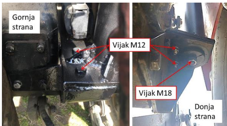
Slika 23 Način vezanja okvira za traktor Zetor 6911 [13]
