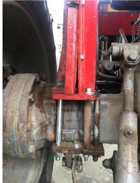
Slika 24 Način vezanja okvira za traktor IMT 560 [10]
