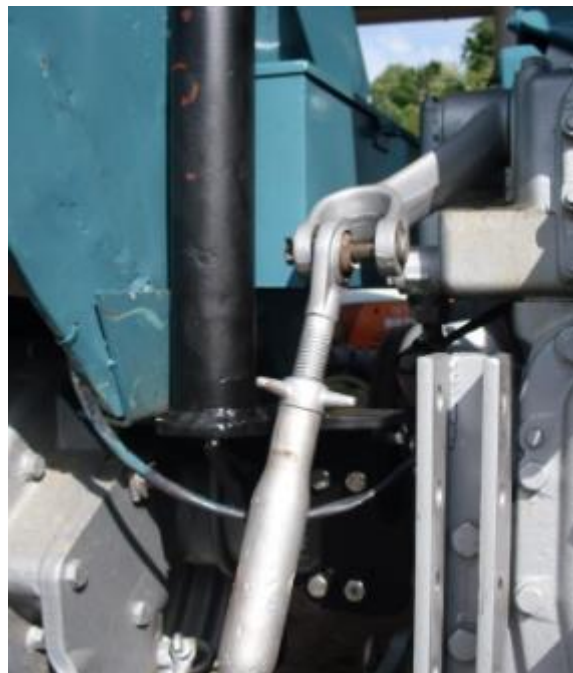
Slika 27 Način vezanja okvira za traktor Rakovica R65 [17]
