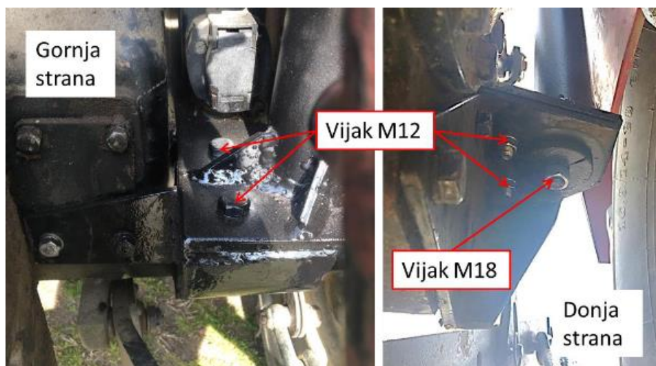
Slika 23 Način vezanja okvira za traktor Zetor 6911 [13]
