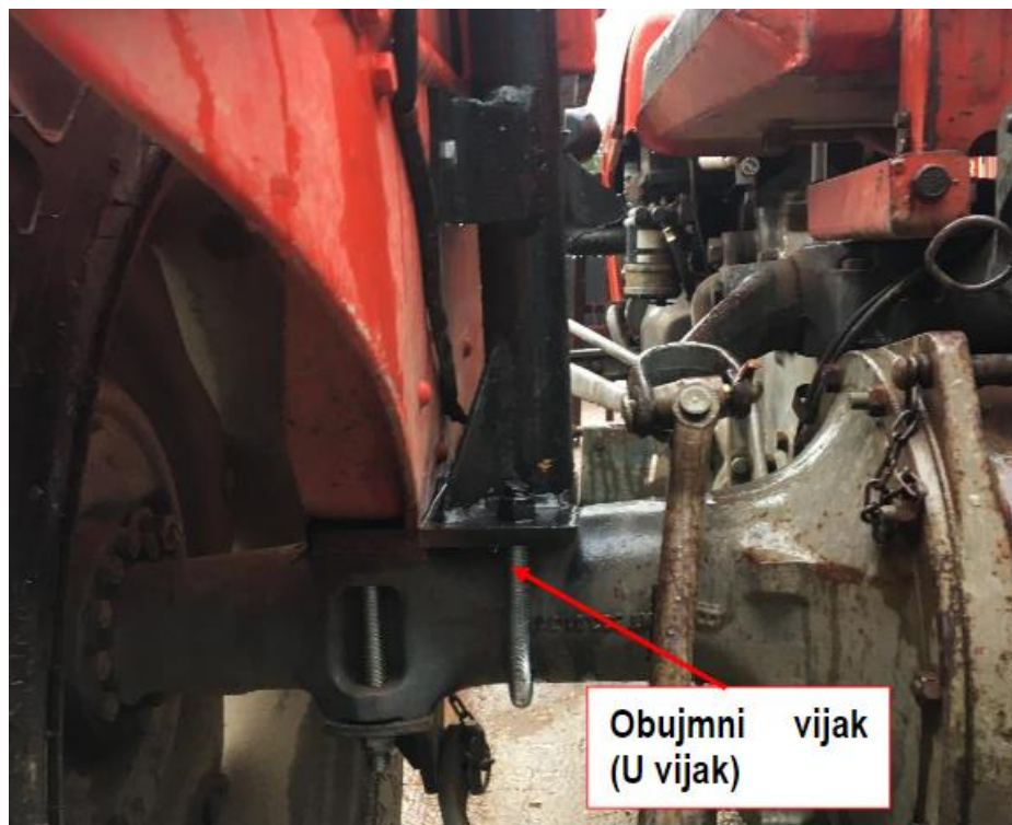
Slika 25 Način vezanja okvira za traktor IMT 539 [12]
