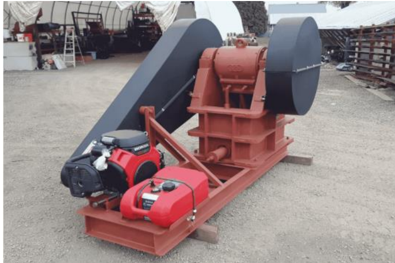
Slika 7. MBMM čeljusna drobilica pogonjena motorom s unutarnjim izgaranjem
