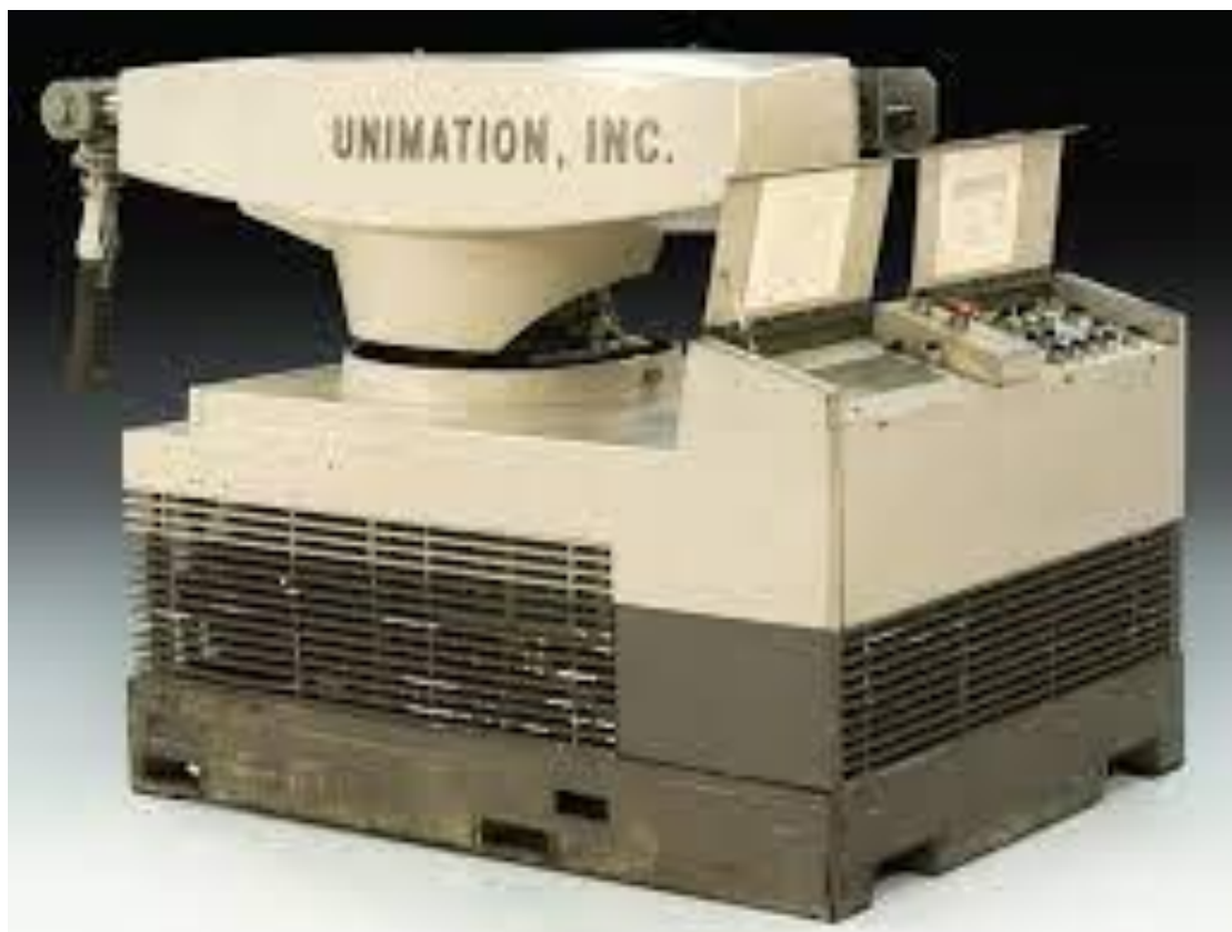
Slika 1. Prvi industrijski moderni robot Unimate [7]
