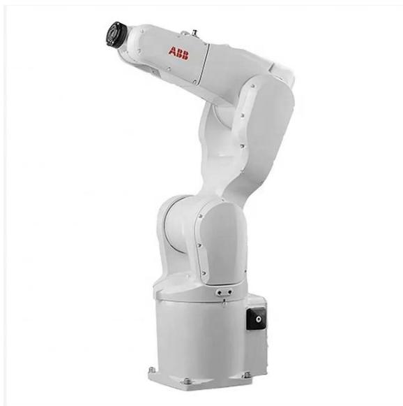
Slika 2. ABB manipulator RRR strukture [8]
