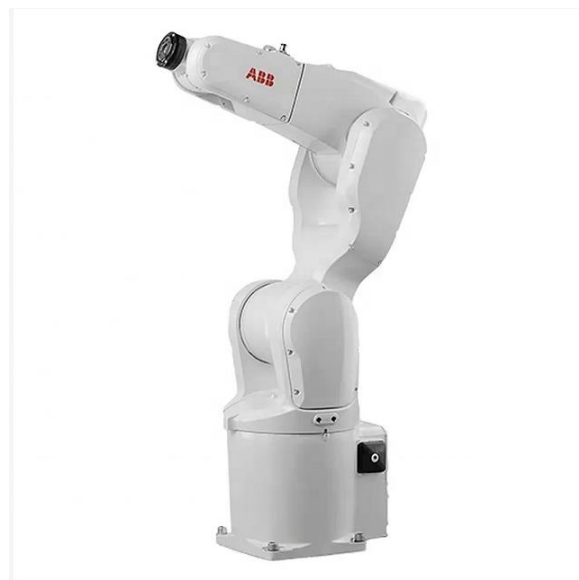
Slika 2. ABB manipulator RRR strukture [8]
