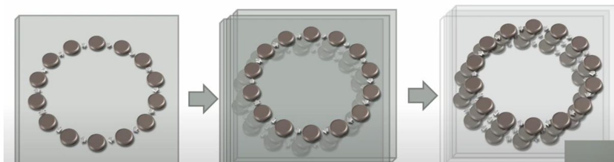
Slika 4: Inkjet bioispis - slojevito
