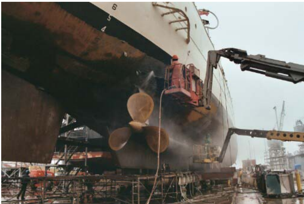
Slika 32. Priprema površine vodenim mlazom [14]
