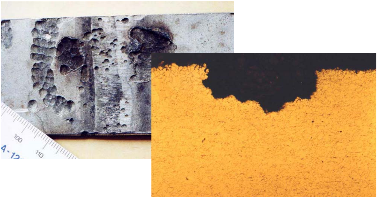
Slika 4. Lokalna korozija (pjegasta) [4]
