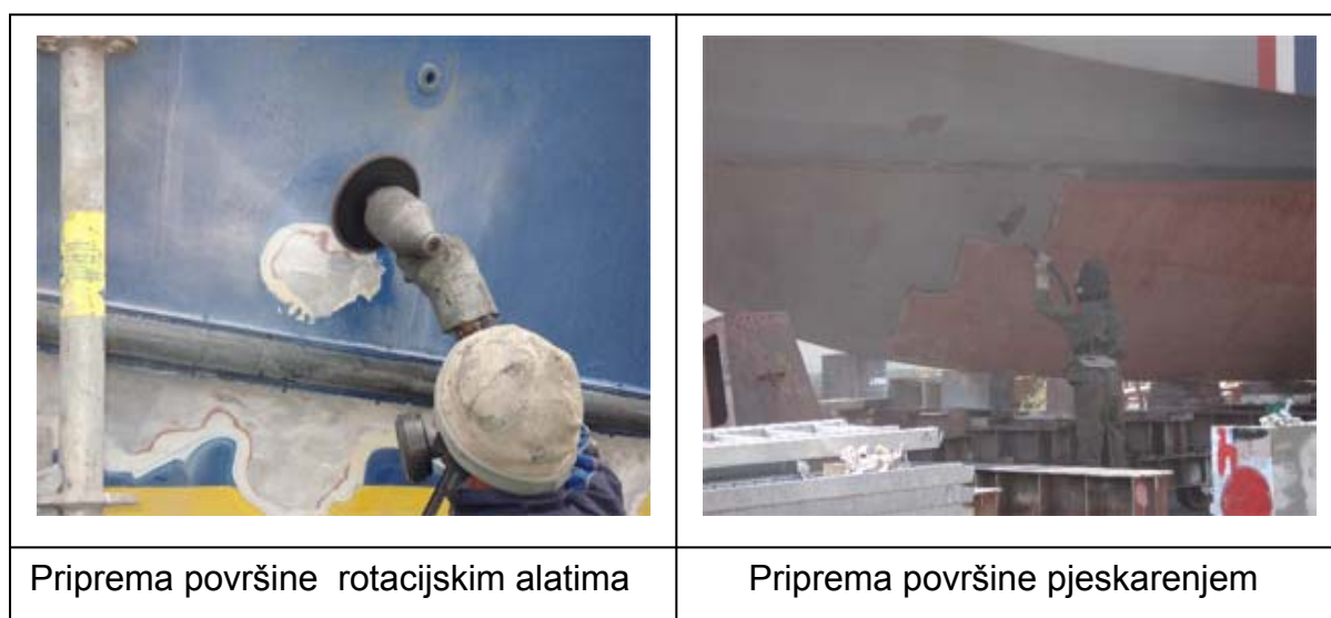
Slika 13. Mehanička priprema površine [7]
