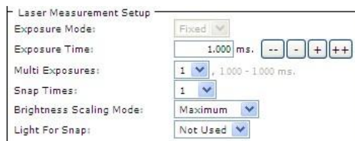
Slika 27: Postavke lasera u 3D vizijskom procesu
