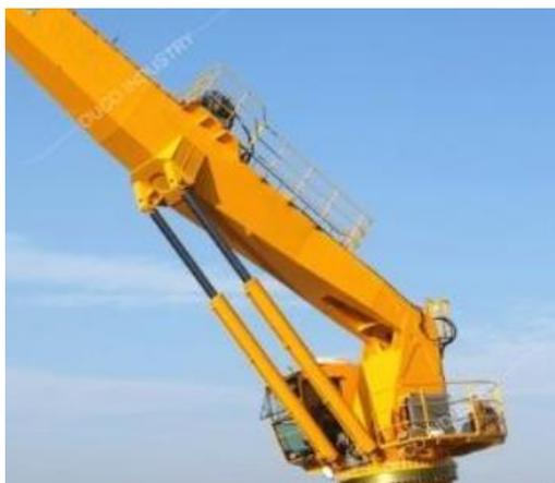
Slika 10 Dohvatnik s hidrauličnim cilindrima [10]
