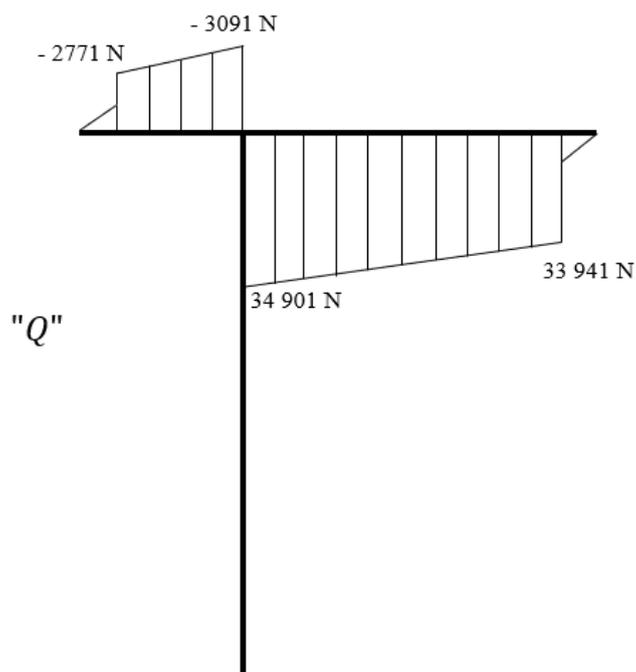
Slika 44 Dijagram unutarnjih poprečnih sila
