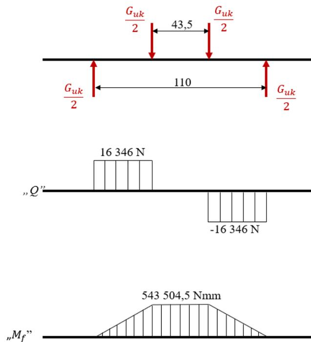
Slika 27 Skica osovine užnica i dijagrami unutarnjih opterećenja
