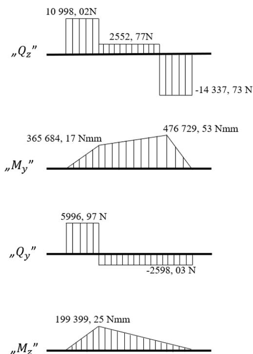
Slika 56 Dijagrami opterećenja osovine skretnih užnica
