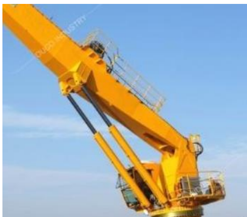
Slika 10 Dohvatnik s hidrauličnim cilindrima [10]
