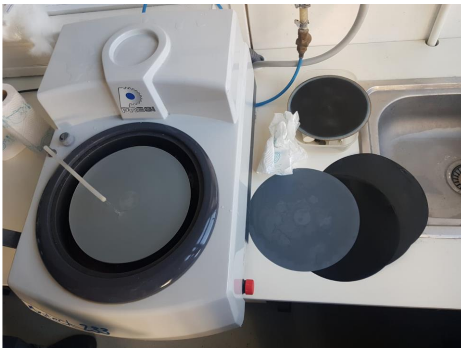
Slika 16: Brusilica za brušenje metalografskog uzorka
