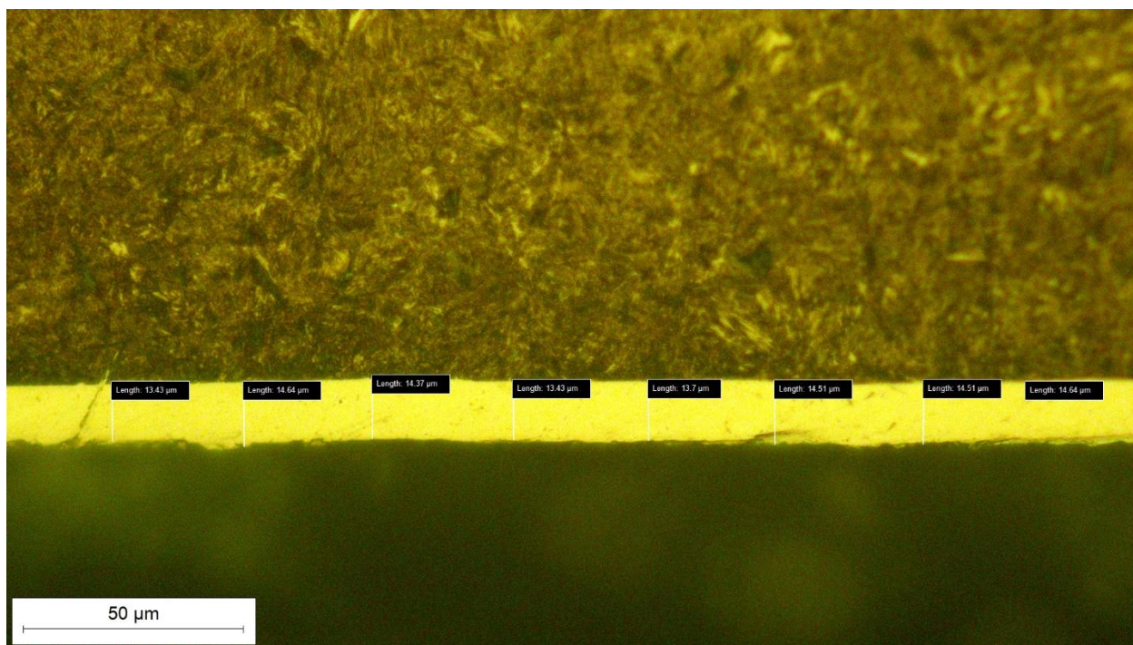
Slika 32: Izmjerene vrijednosti debljine prevlake nikla
