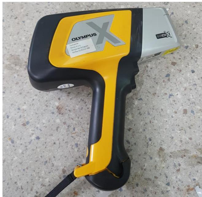
Slika 19: Aparat za XRF analizu
