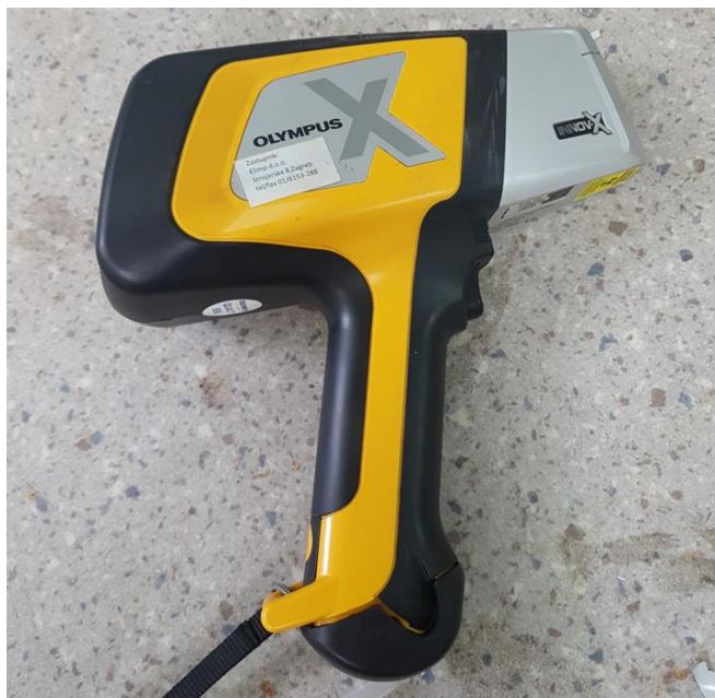
Slika 19: Aparat za XRF analizu
