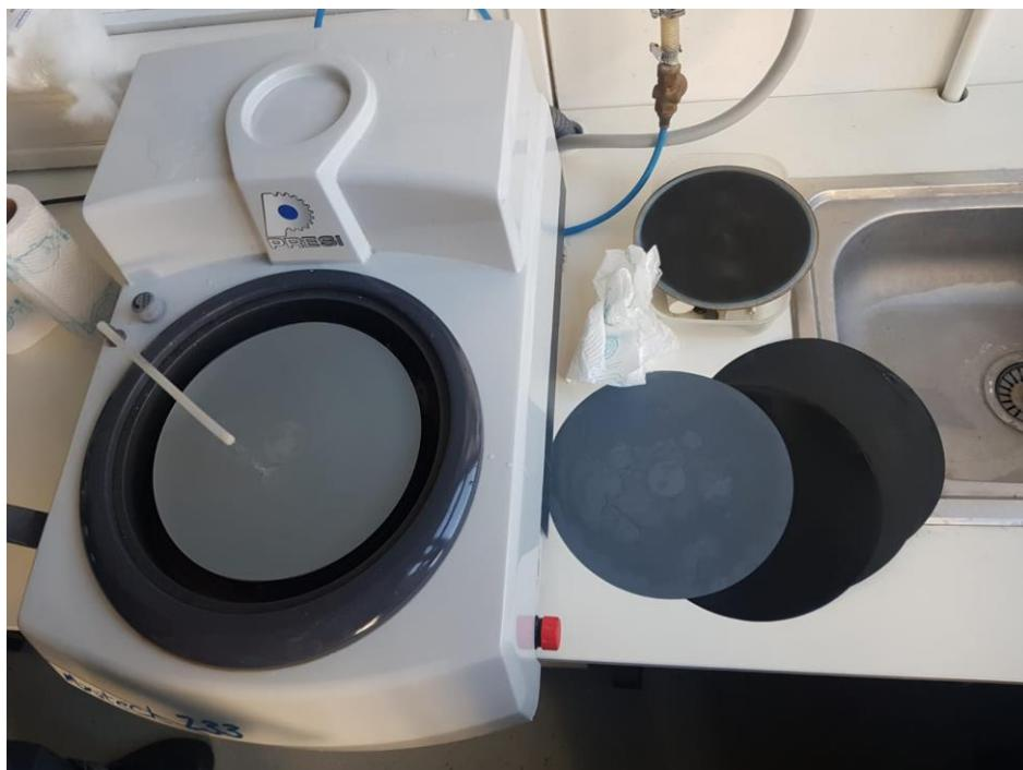
Slika 16: Brusilica za brušenje metalografskog uzorka
