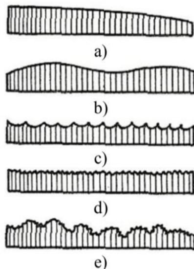
Slika 7: Osnovne vrste odstupanja površine: a) neparalelnost, b) valovitost, c) izbrazdanost, d) hrapavost, e) rezultantna realna površina [11]
