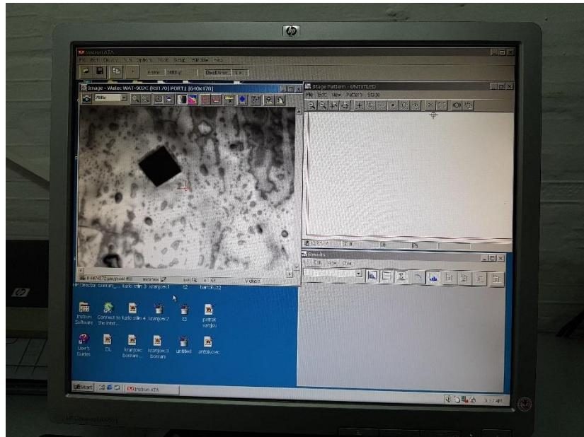
Slika 27: Otisak indentora u ispitivanju tvrdoće metodom Vickers
