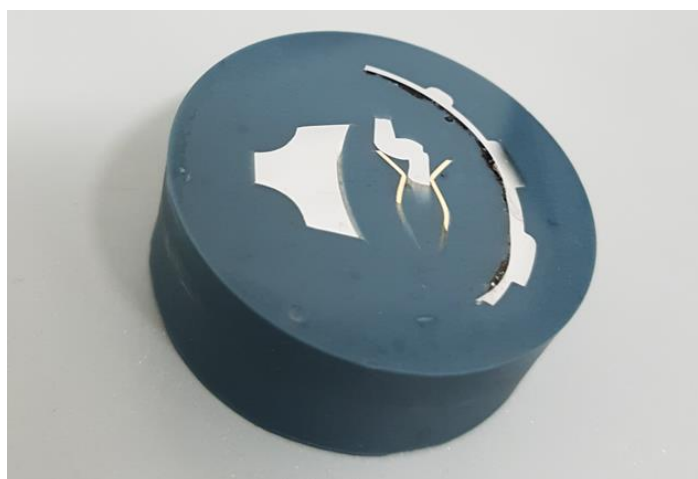
Slika 18: Polirani metalografski uzorak
