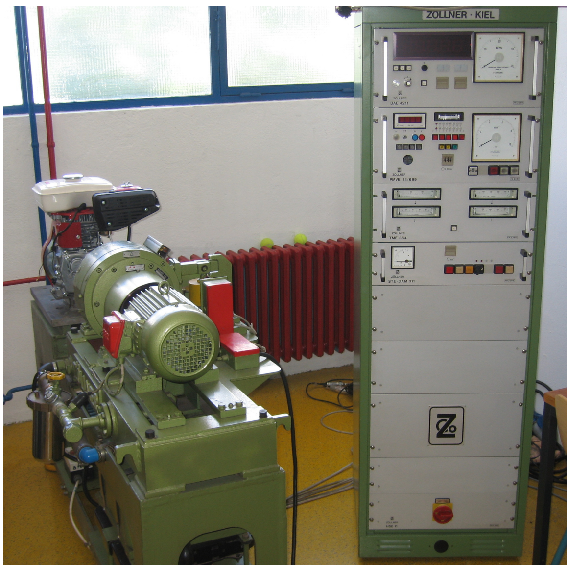
Slika 1.1. Električna kočnica ZÖLLNER tipa VA-100AC DAM4PS
