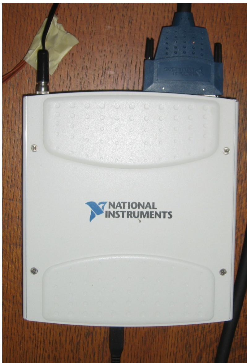
Slika 6.8. Analogno - digitalni pretvarač NI USB 6251
