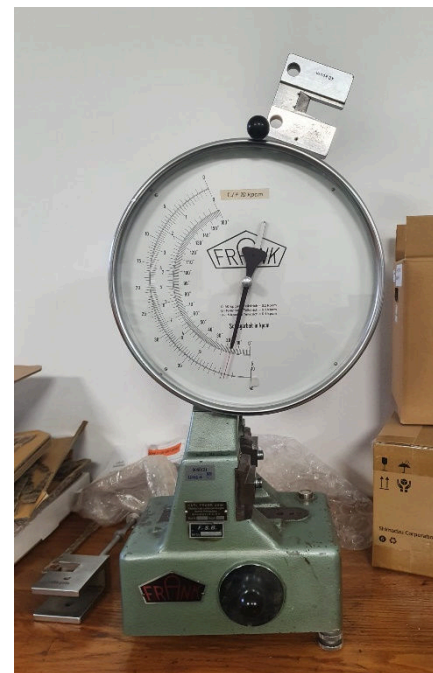
Slika 44. Charpy-ev bat: a) shematski prikaz [16], b) korišten charpy-ev bat
