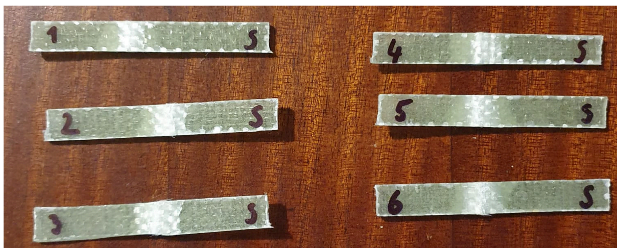
Slika 48. Epruvete kompozita ojačanog staklenim vlaknima nakon ispitivanja žilavosti
