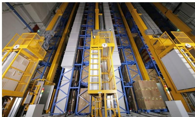
Slika 33. Visokoregalno automatizirano skladište ("unit – load" AS/RS)
