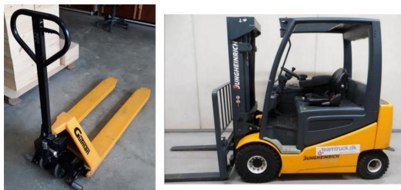
**Slika 35. Ručni viličar (lijevo) i električni čoni viličar (desno)**
