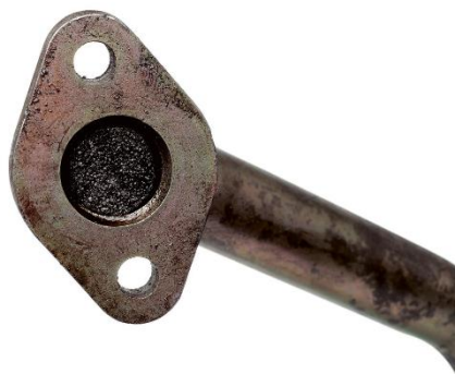
Slika 28. Začepljenje vodova uslijed karbonizacije ulja [11]
