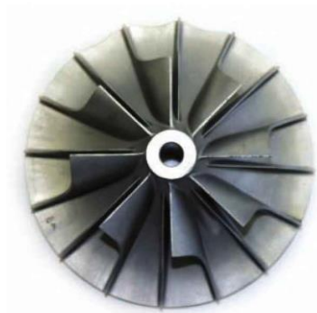
Slika 15. Rotor kompresora s radijalnim lopaticama [15]
