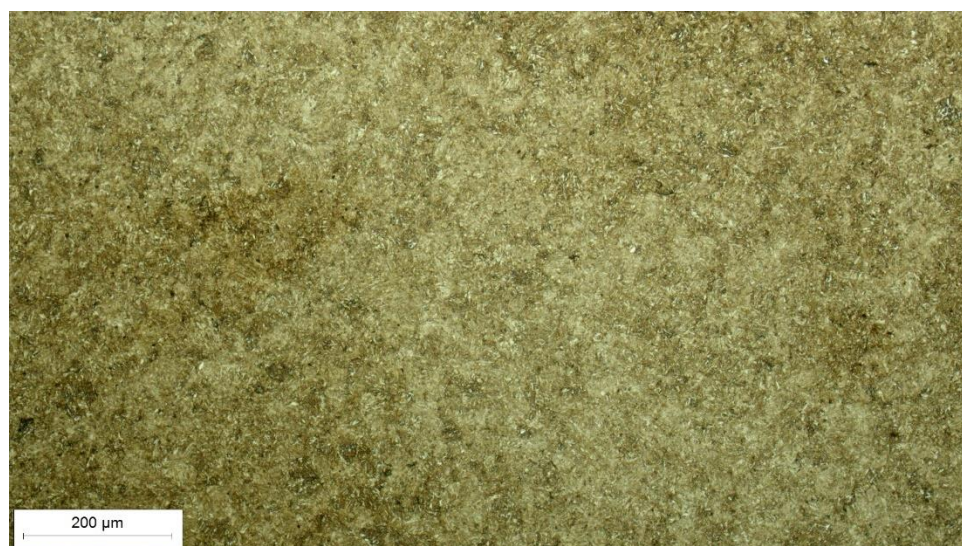
Slika 69. Martenzitna mikrostruktura spojnog vratila, povećanje 200x
