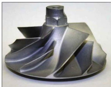
Slika 17. Rotor s naizmjenično kraćom lopaticom [15]
