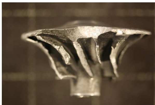
Slika 51. Lomna površina rotora kompresora (pogled po uzdužnoj osi)
