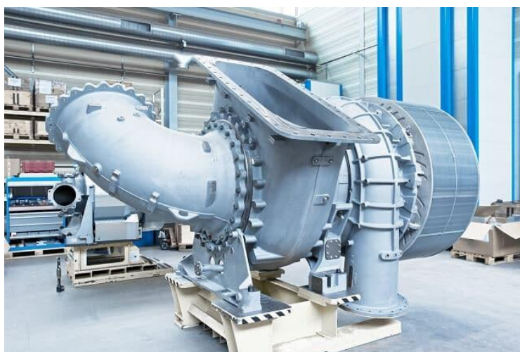
Slika 5. Turbopunjači za brodogradnju [34]
