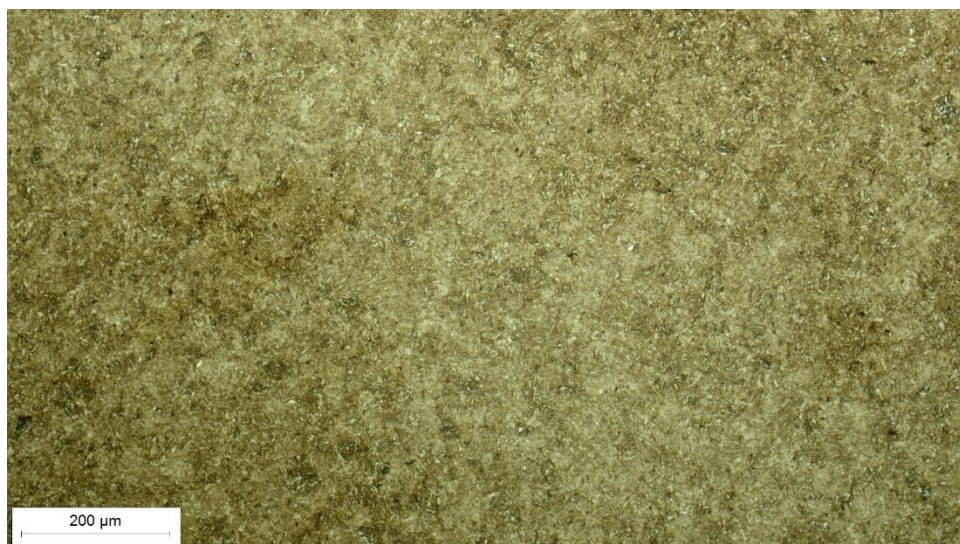
Slika 69. Martenzitna mikrostruktura spojnog vratila, povećanje 200x
