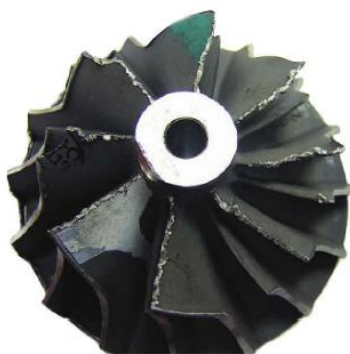
Slika 23. Oštećenja lopatica na rotoru kompresora uzrokovana prodorom stranog tijela [15]
