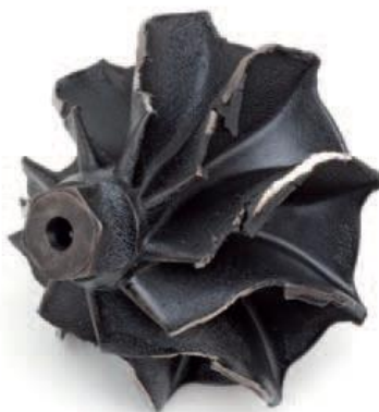
Slika 25. Oštećeni rotor turbine nakon kontakta s kućištem [11]
