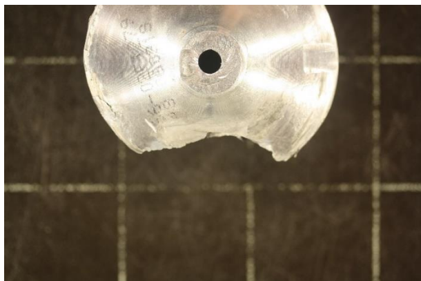
Slika 52. Lomna površina rotora kompresora (pogled u tlocrtu)
