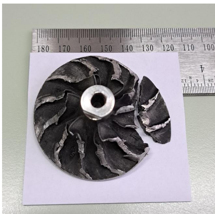
Slika 39. Lom rotora kompresora
