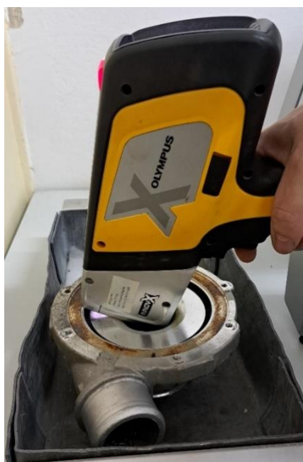
Slika 43. XRF analiza kućišta kompresora
