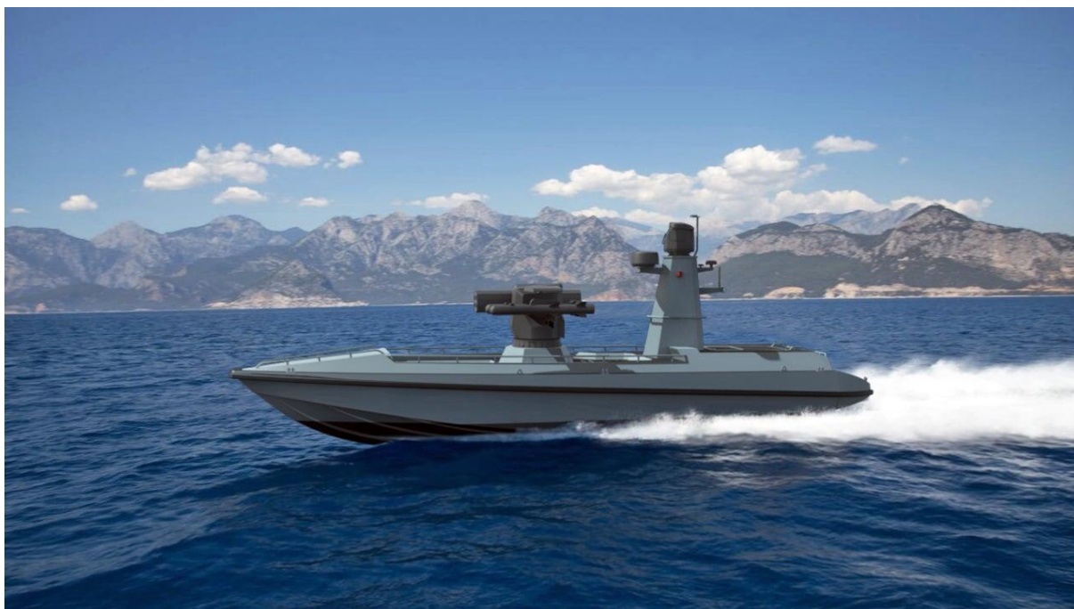
Slika 6 ULAQ ASUV – ravna paluba bez nadgrađa [4]
