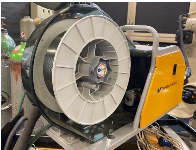
Slika 29. Kolut sa žicom u mehanizmu za dovođenje žice
