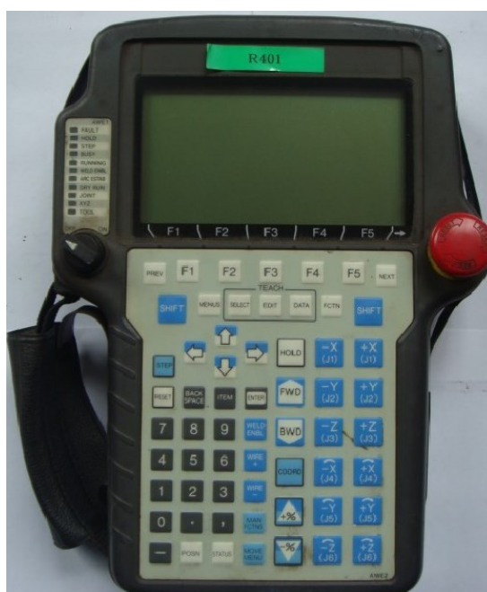
Slika 22. Privjesak za učenje („on - line“ programiranje) [31]
