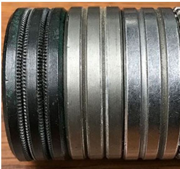
Slika 2. Vrste pogonskih kotačića, s lijeva na desno: nazubljeni utor, V utor i U utor [10]
