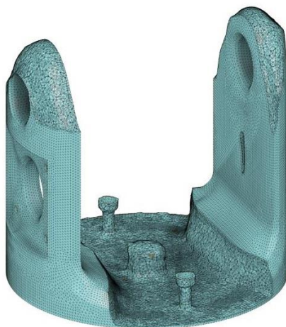
Slika 26. Topološki optimirano rame u programu Fusion 360
