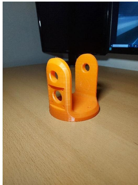
**Slika 17. Isprintano rame robota**
