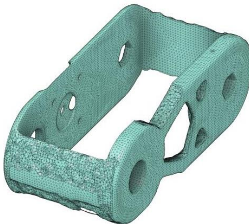
Slika 27. Topološki optimirana nadlaktica u programu Fusion 360
