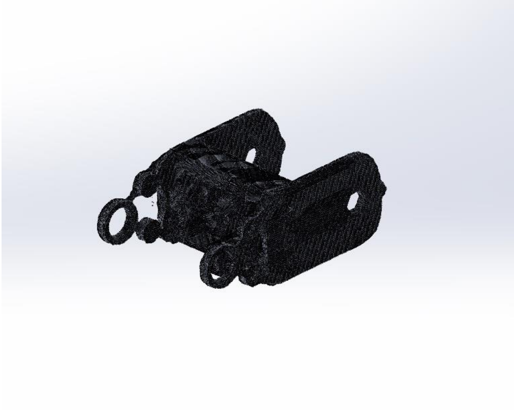
Slika 24. Topološki optimirana podlaktica u programu Solidworks
