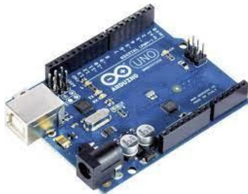
Slika 3. Arduino UNO mikrokontroler
