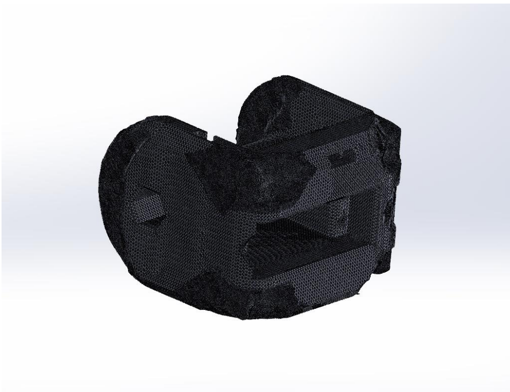
Slika 25. Topološki optimirano zapešće u programu Solidworks
