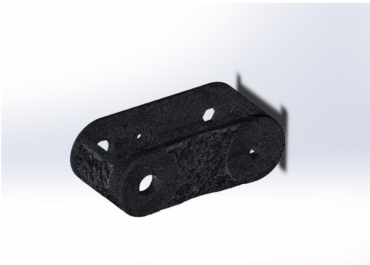
Slika 22. Topološki optimirano rame u programu Solidworks
