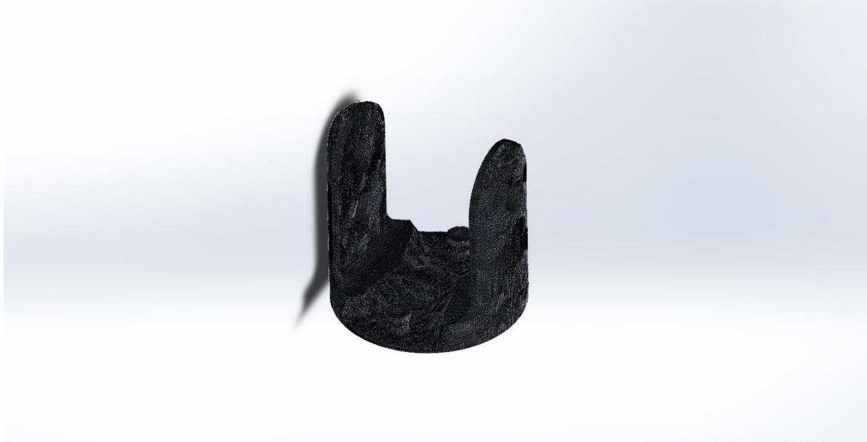
**Slika 22. Topološki optimirano rame u programu Solidworks**
