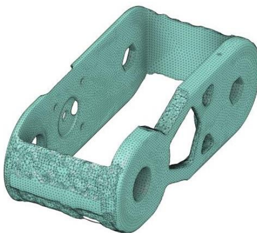
Slika 27. Topološki optimirana nadlaktica u programu Fusion 360
