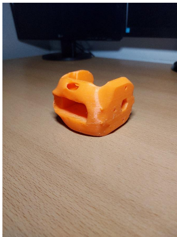
Slika 42. Isprintana optimirana podlaktica
