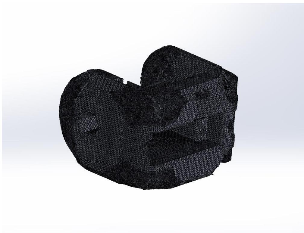
**Slika 25.** Topološki optimirano zapešće u programu Solidworks
