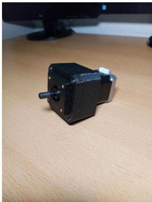
**Slika 16. Planetarni reduktor s koračnim motorom**
