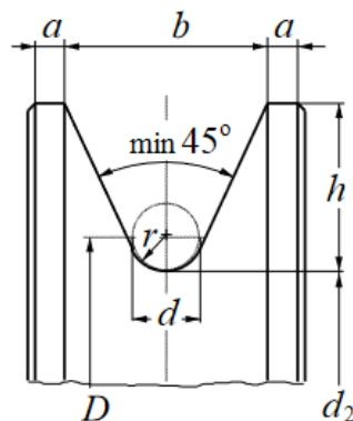
Slika 40 presjek užnice [1]
