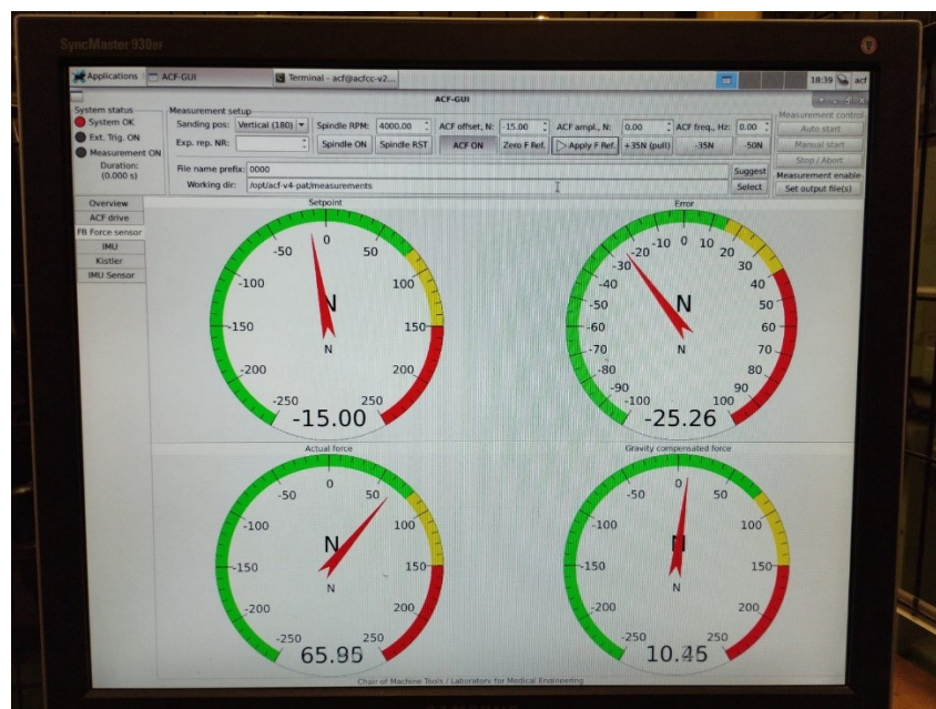
Slika 7. Program za snimanje i praćenje parametara procesa obrade
