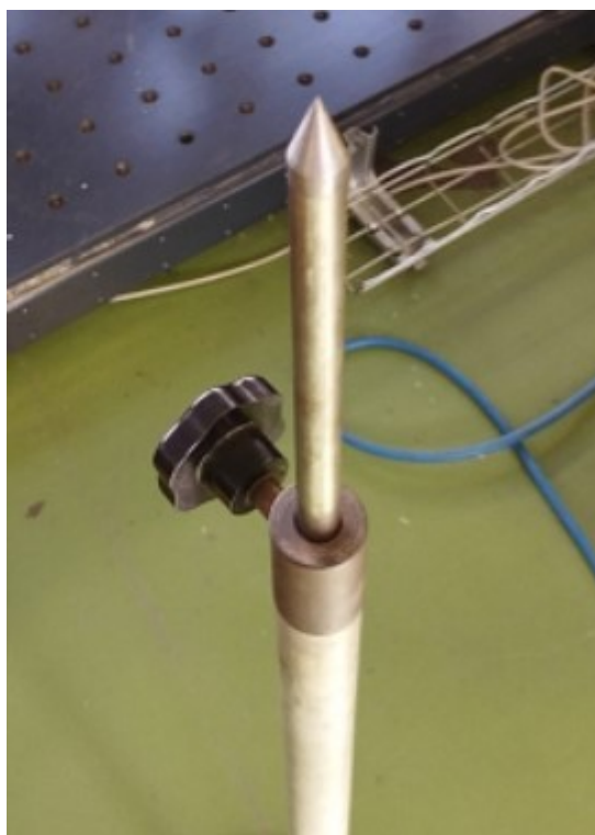
Slika 30. Fiksni šiljak za umjeravanje
