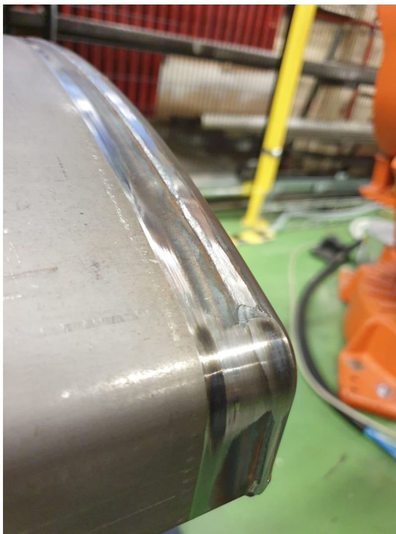
Slika 36. Izgled zavara po dijelovima nakon prvog prolaza alata
