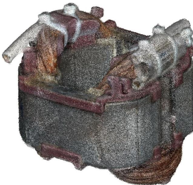
**Slika 33. Pojednostavljeni oblak s udaljenosti točaka 0,1 mm**
