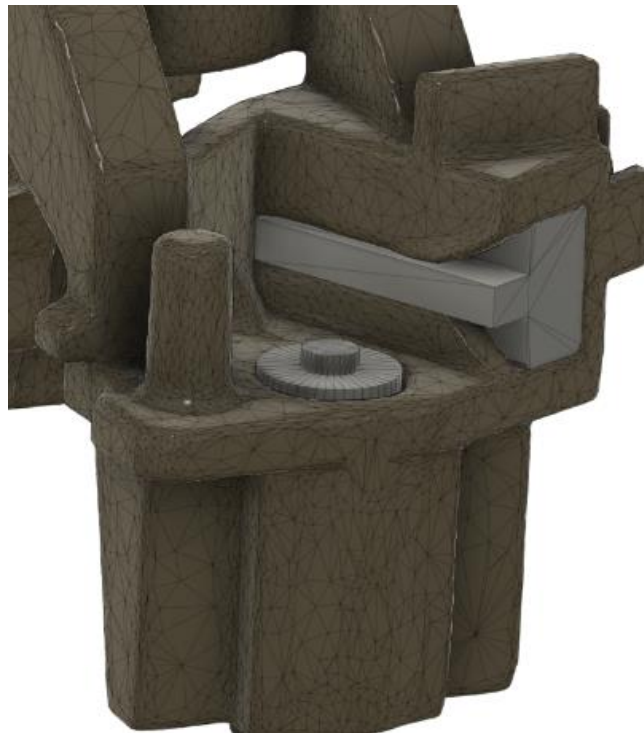
Slika 44. Modeliranje mreže nedostajućih značajki
