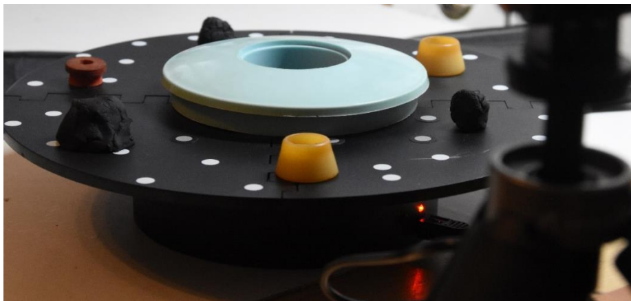
Slika 25. Dodavanje značajki korištenih za praćenje u okolinu komponente skenirane na okretnom stoliću
