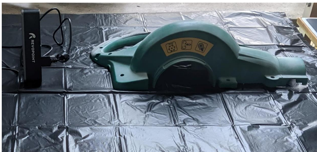
Slika 17. Pripremljeno kućište Bosch puhalice za ručno skeniranje
