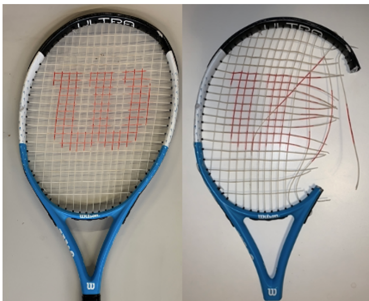
Slika 15. Reket prije i nakon izrezivanja ispitnih tijela
