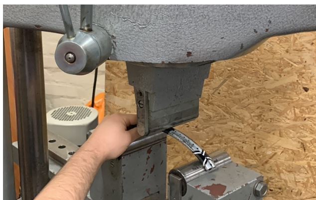
Slika 19. Postavljanje ispitnog tijela 1 u kidalicu
