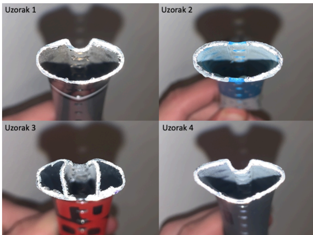
Slika 23. Presjeci ispitnih tijela nakon rezanja
