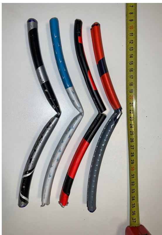
Slika 21. Ispitna tijela nakon ispitivanja
