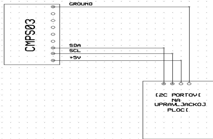
Slika 27 Shema spajanja kompasa s upravljačkom pločom IntelliBrain2
