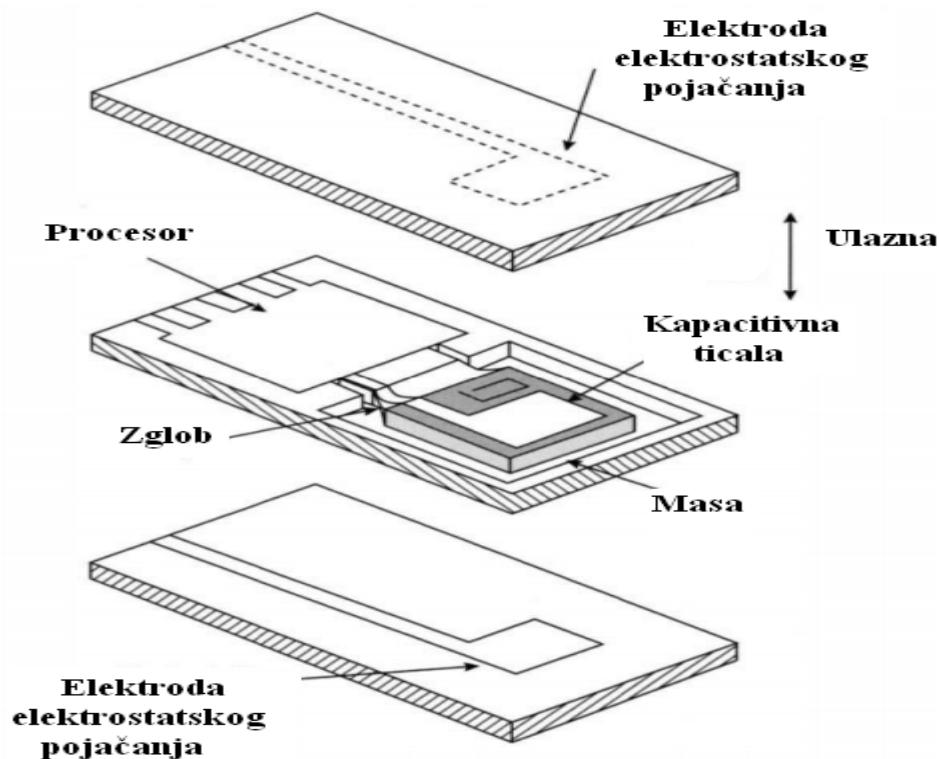
Slika 13 Silicijski akcelerometar
