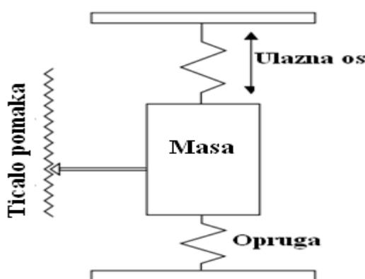
Slika 10 Princip akcelerometra
