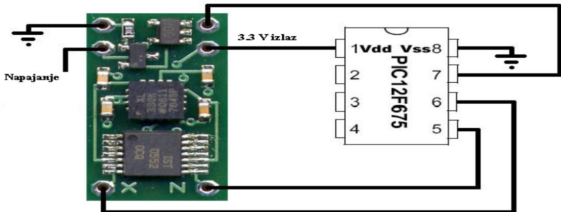
**Slika 22 Spoj akcelerometra s mikrokontrolerom**
