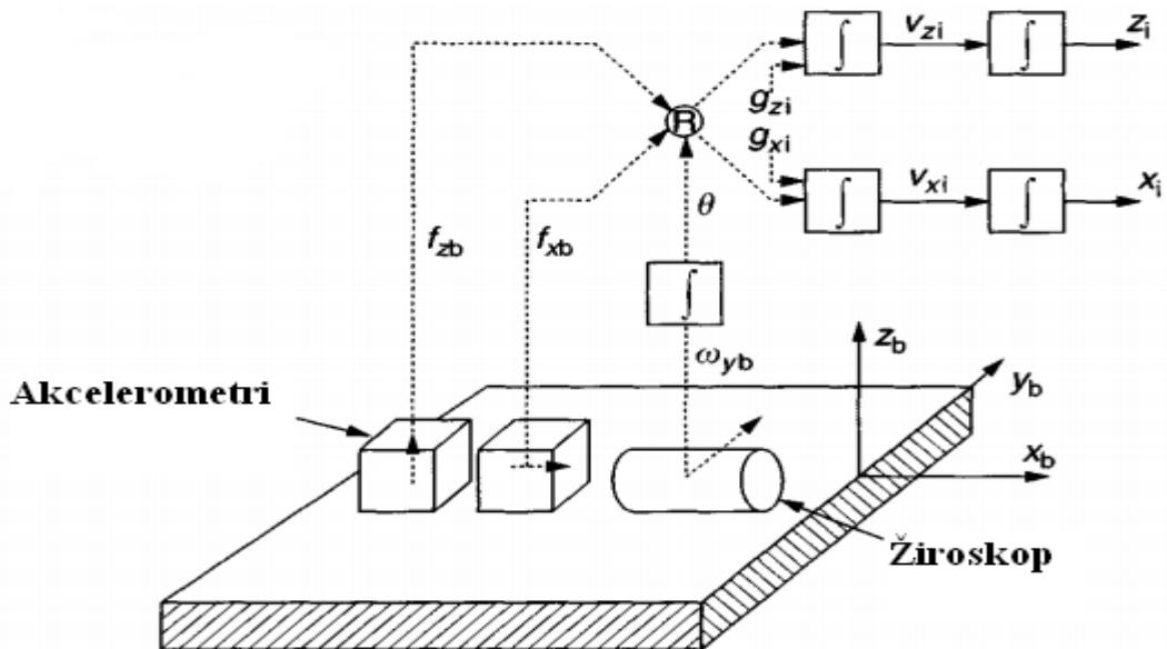
**Slika 41 Komponente dvodimenzionalnog sustava inercijalne navigacije**
