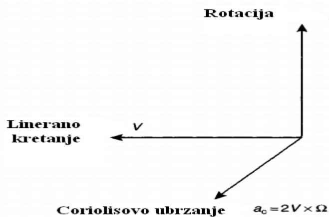
Slika 2 Generiranje Coriolisove sile
