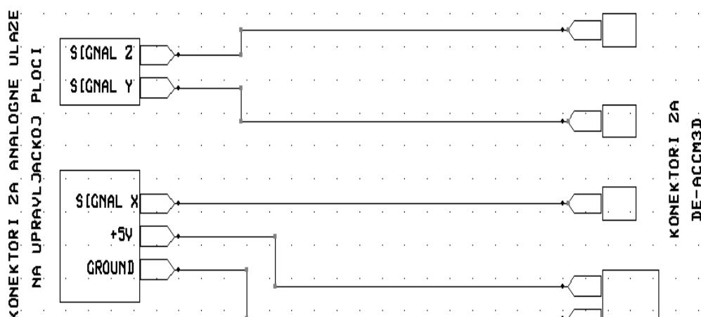
Slika 28 Konektor za povezivanje akcelerometra s upravljačkom pločom
