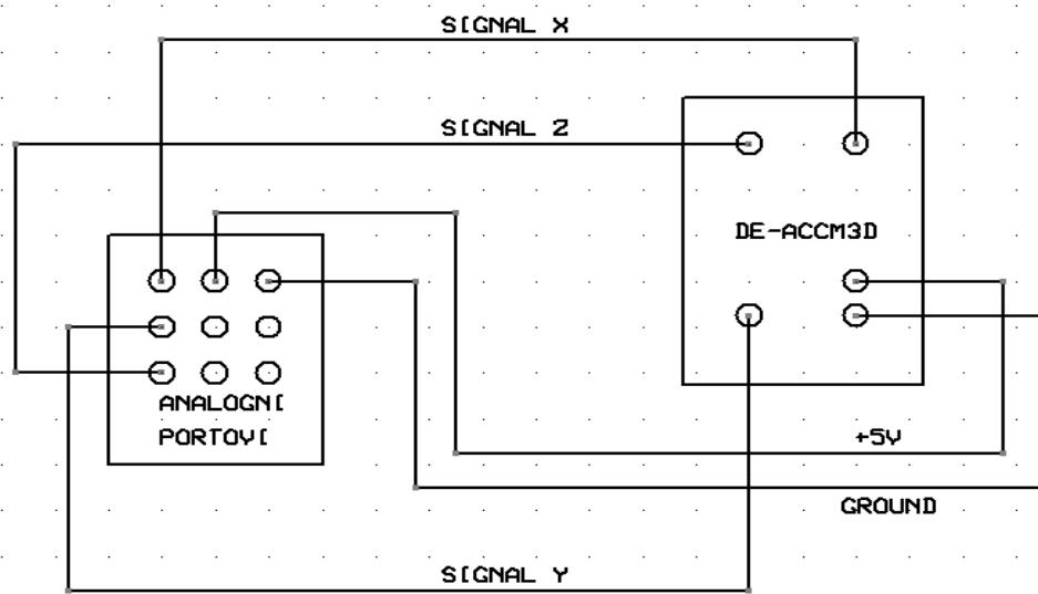
**Slika 29 Shema spajanja akcelerometra s upravljačkom pločom**
