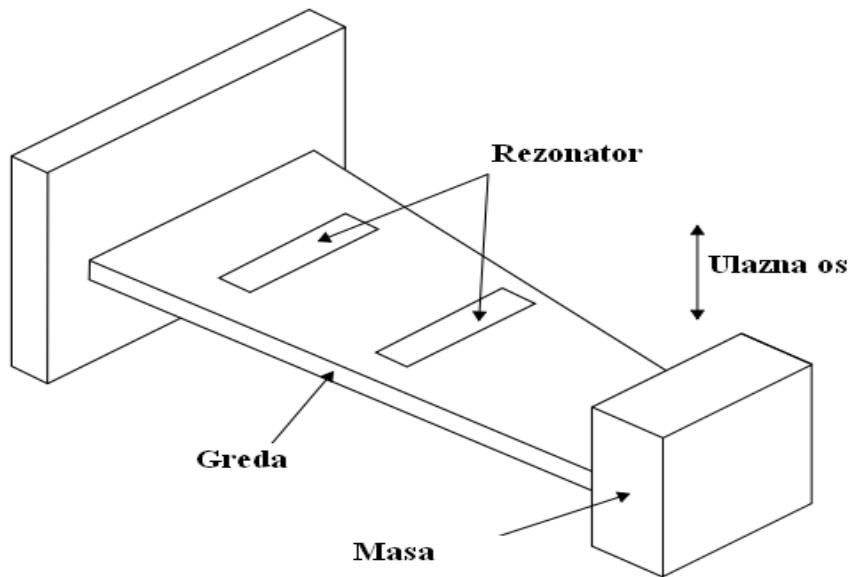
**Slika 11 SAW akcelerometar**
