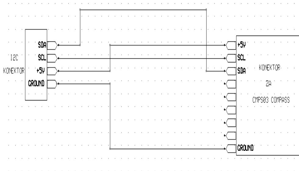
Slika 26 Konektor za povezivanje kompara i IntelliBrain2 upravljačke ploče
