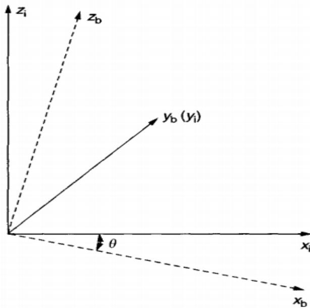
**Slika 42 Primjer osi dvodimenzionalnog inercijalnog navigacijskog sustava**
