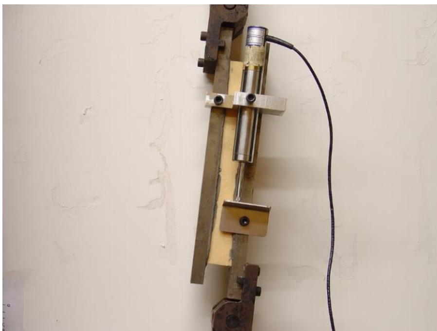
Slika 4.1 Ispitivanje jezgre sendviča prema ASTM C273 [3]
