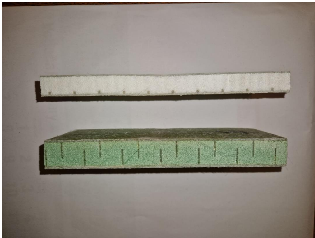
Slika 5.4 Ispitna tijela tanjeg i debljeg sendviča
