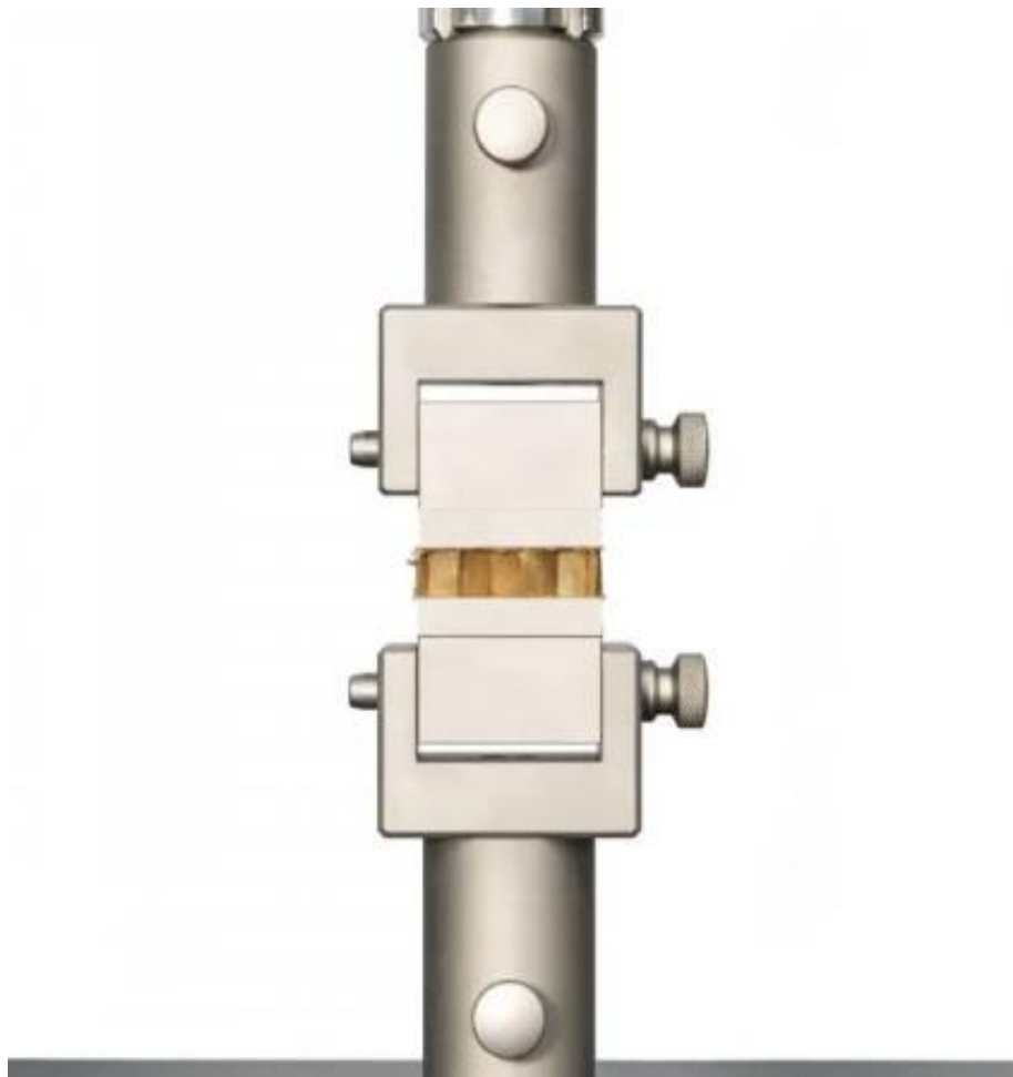
Slika 3.2 Rastezno ispitivanje sendviča okomito na slojeve ojačanja [10]
