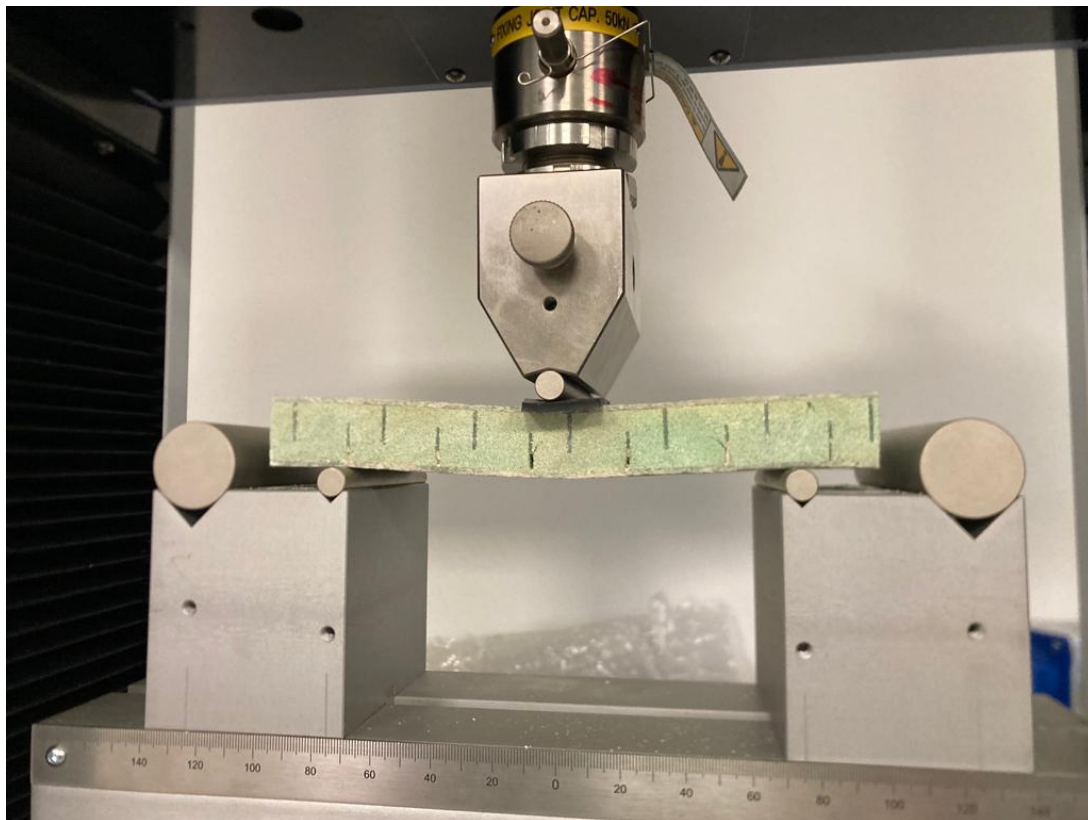
Slika 5.5 Opterećeno ispitno tijelo sendviča
