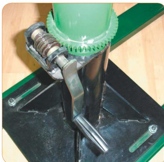
Slika 13. Okretanje sustavom zupčanika [10]
