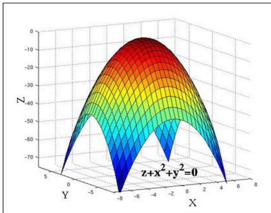
Slika 1: Primjer optimuma/maksimuma nelinearne funkcije cilja (paraboloid)
