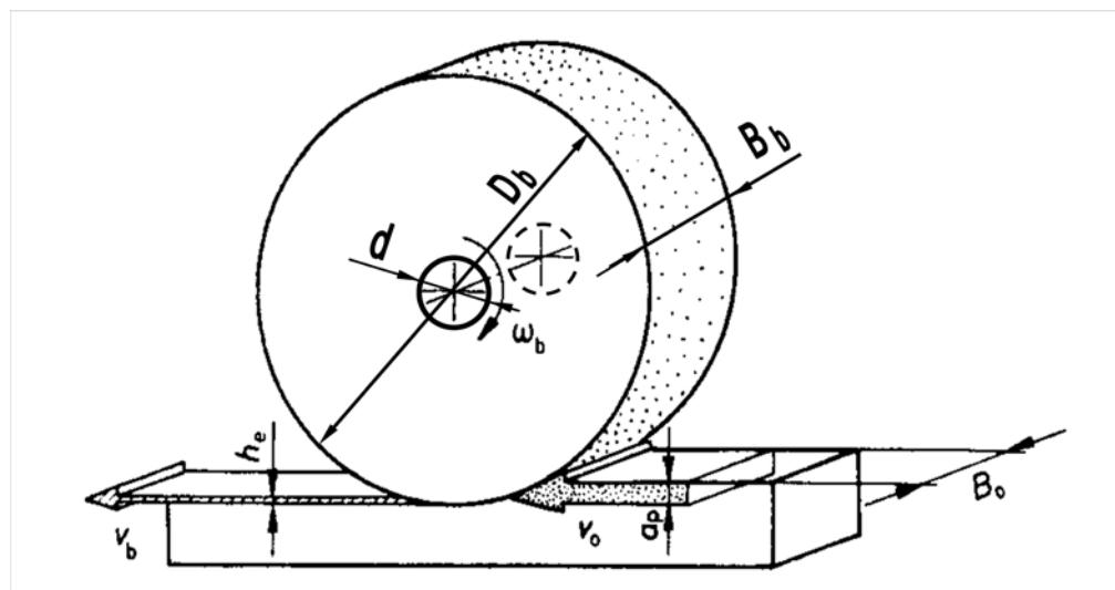
Slika 29: Obodno brušenja ravne površine, istosmjernim uzdužnim načinom
