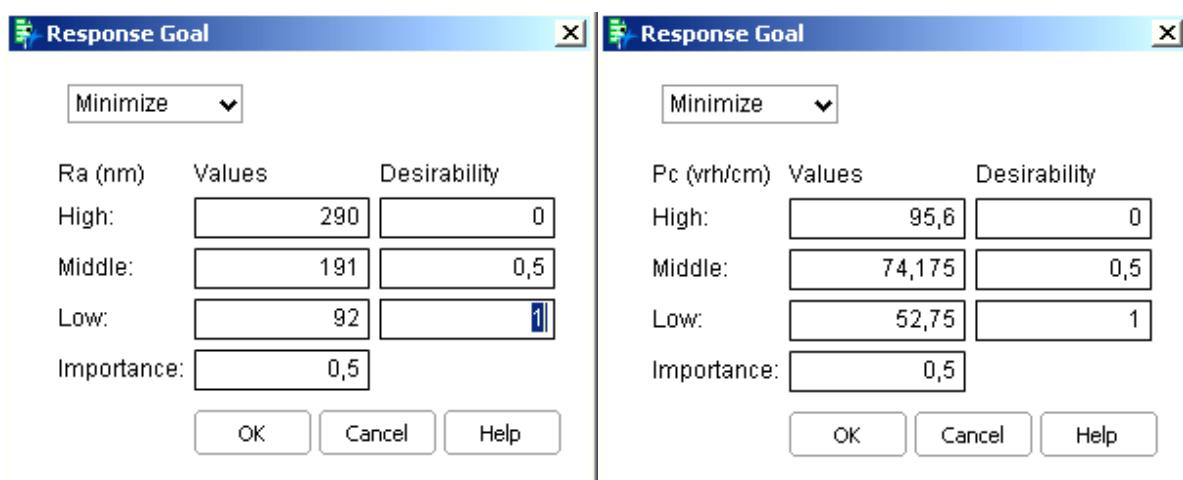
Slika 43: Postavljanje vrijednosti za pojedinačne funkcije poželjnosti modela  $R_a$  i  $P_c$
