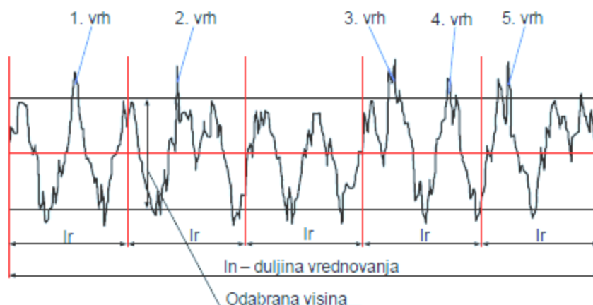
Slika 30: Definicija parametra P_c , odnosno broja vrhova elementa profila, [18]
