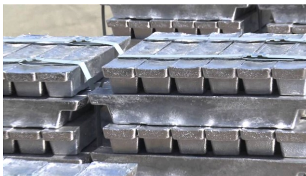
Slika 7. Ingoti olova nakon rafinacije [12]
