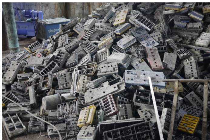
Slika 19. Rastavljeni akumulatori za recikliranje [31]
