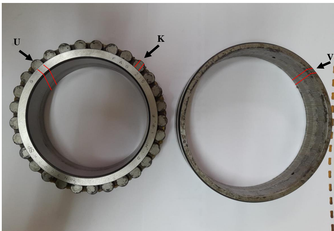
Slika 18. Mjesta rezanja dijelova ležaja
