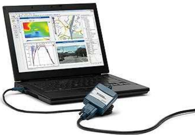
Slika 6.14. Fotografija prikazuje uređaj NI USB 8473s spojen sa računalom te izgled obrađenih podataka prikupljenih sa CAN sabirnice.
