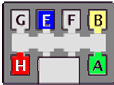
Slika 2.3. Slika prikazuje 6 pinski dijagnostički priključak za OBD I (uglavnom se nalazi u australskim vozilima) [25].
