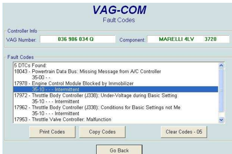
Slika A.11. Pogreške očitane sa motornog sklopa.
