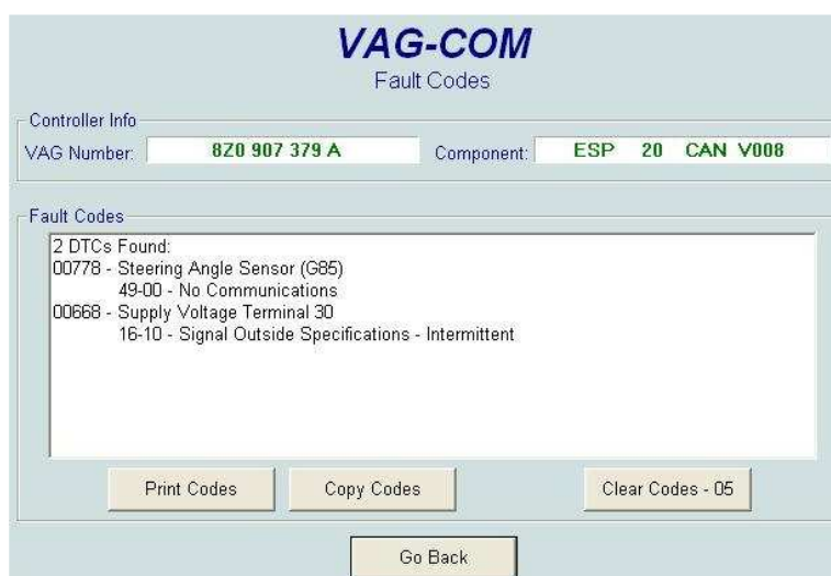
Slika A.13. Očitane pogreške na sustavu ABS-a.
