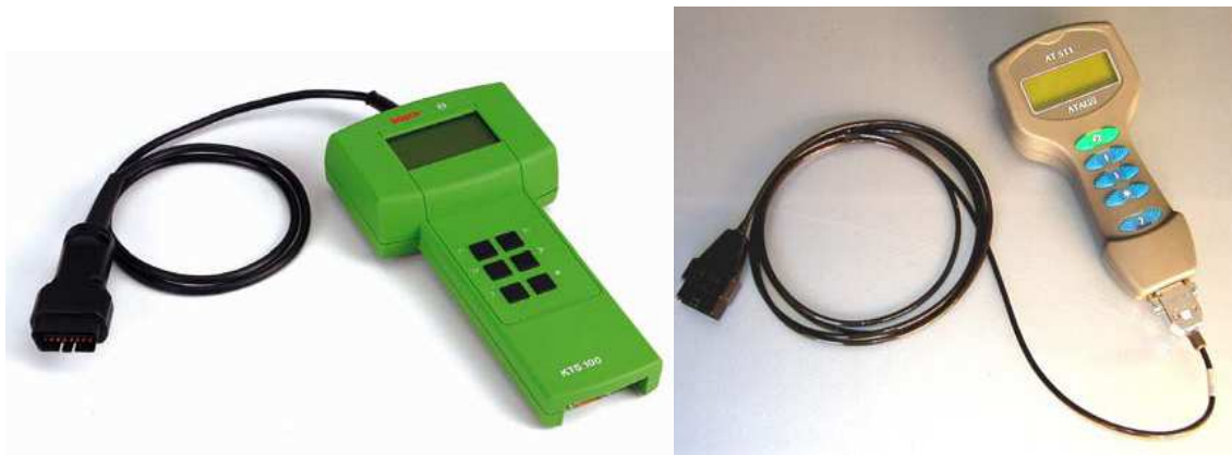
Slika 6.1. Dijagnostički uređaj BOSCH KTS 100 (lijevo); dijagnostički uređaj ATAL AT 511 (desno). Oba uređaja su univerzalna i opremljena su dijagnostičkim kabelom za priključivanje na CARB priključnicu i normiranim EOBD sustavom.
