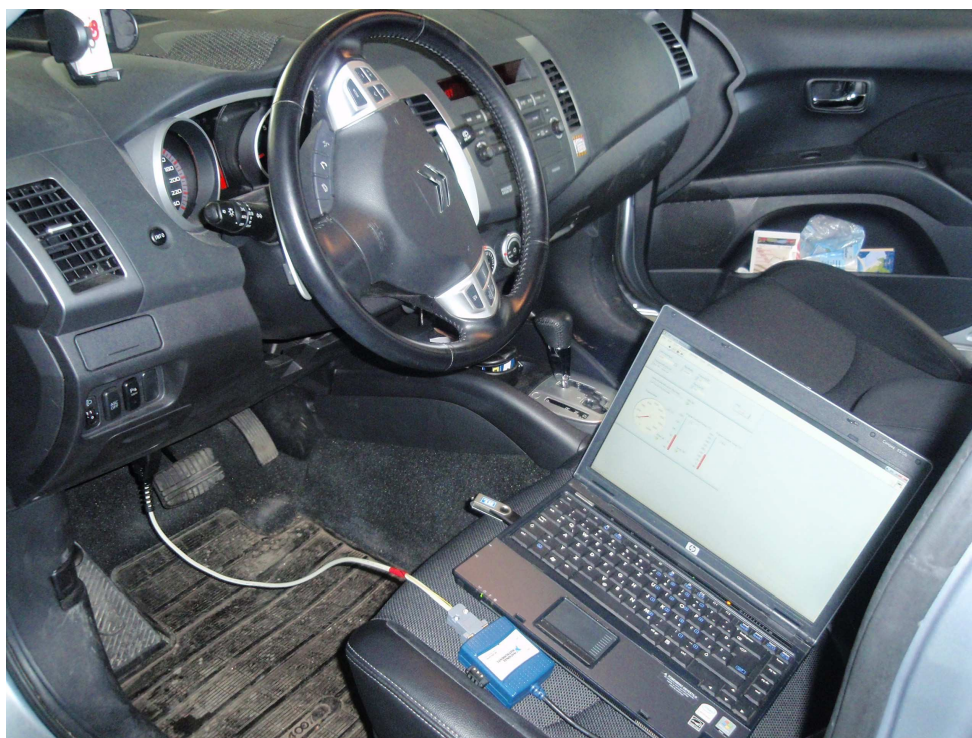
Slika 7.8. Spoj NI USB-8473s uređaja sa vozilom i računalom.
