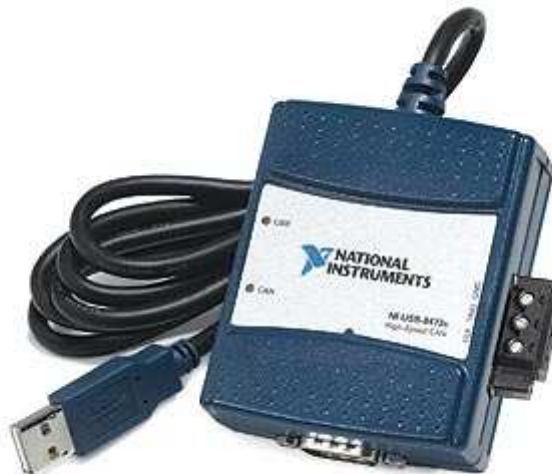
Slika 6.13. Uređaj NI USB-8473s.
