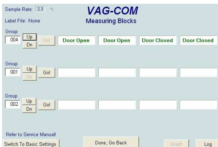
Slika A.27. Mjerni blokovi komfora.
