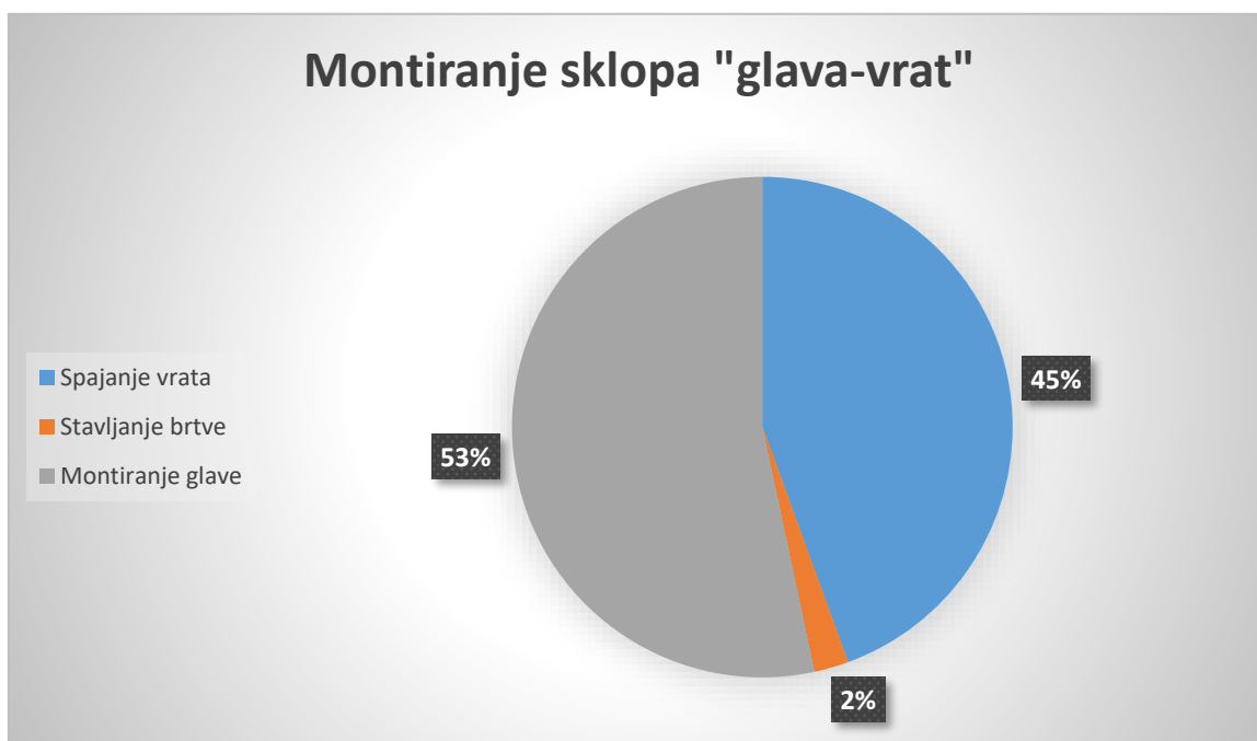
Slika 31. Grafikon faze montiranja sklopa "glava-vrat"
