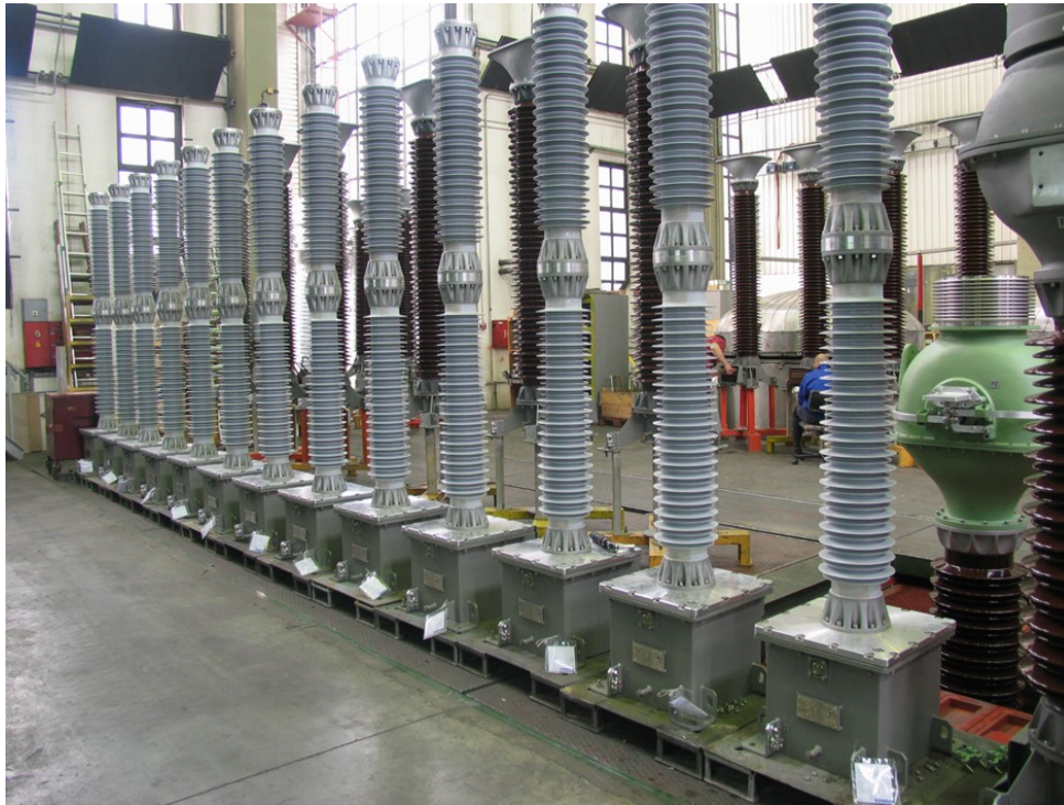
Slika 10. Mjerni transformator tipa VCU [7]
