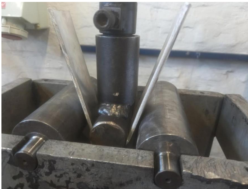
Slika 34. Prikaz ispitivanja savijanjem u Laboratoriju za zavarivanje na FSB-u
