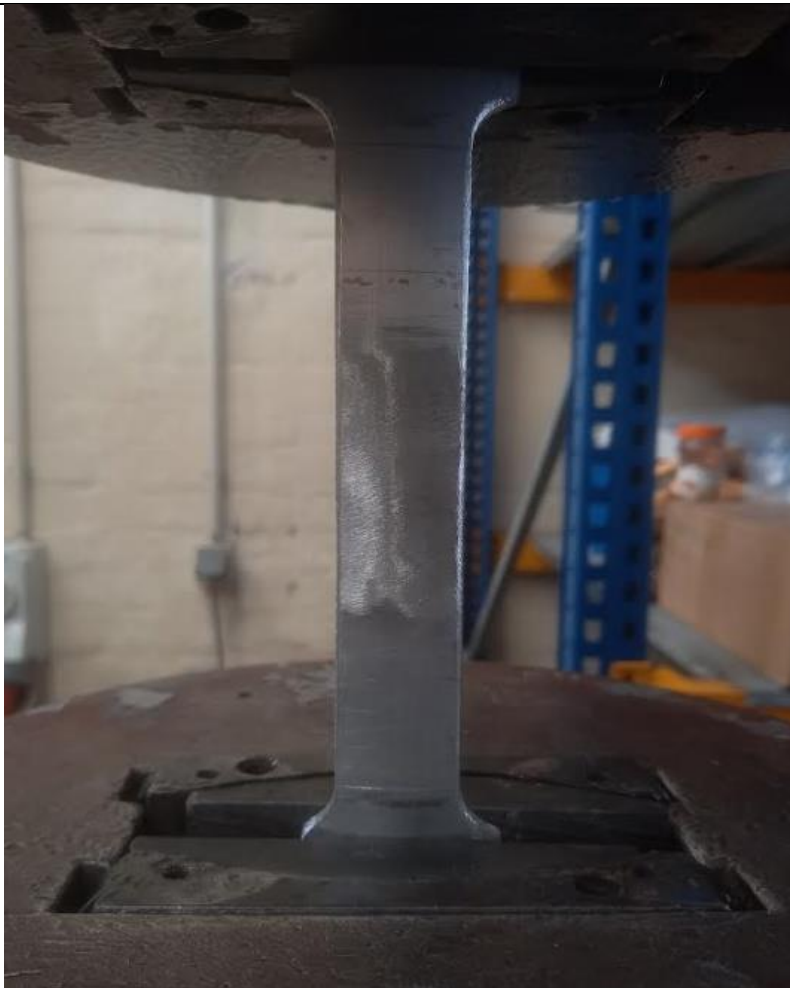
Slika 30. Epruveta ukliještena u kidalici
