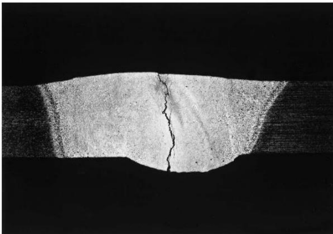
Slika 2. Prikaz tople pukotine nastale tijekom zavarivanja aluminija[5]
