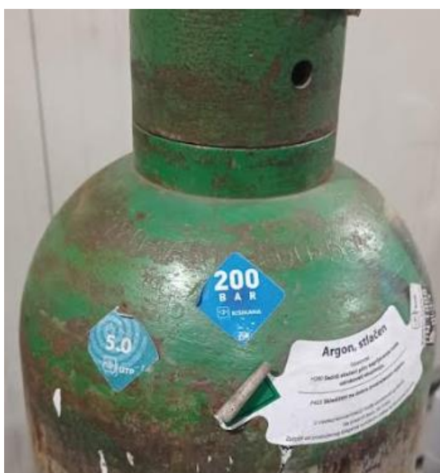
Slika 16. Boca zaštitnog plina Argon 5.0
