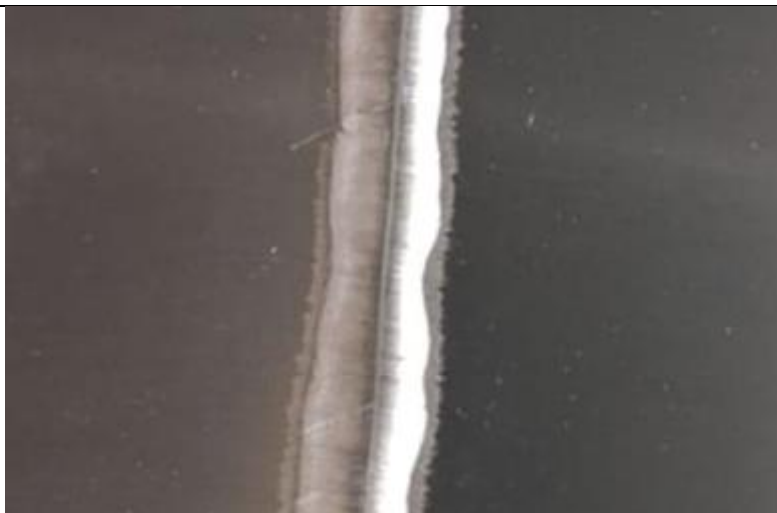
Slika 20. Prikaz uzdužnog zareza na površini korijena zavara zavarenog bez skošenja na unutarnjem rubu cijevi
