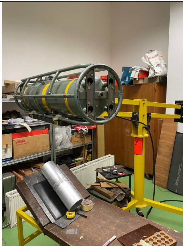
Slika 27. Priprema za radiografsko snimanje uzorka
