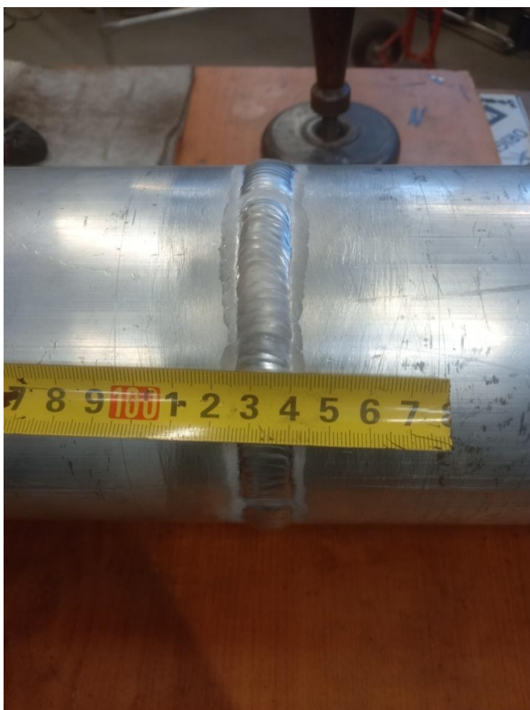
Slika 23. Izgled zavara nakon drugog prolaza
