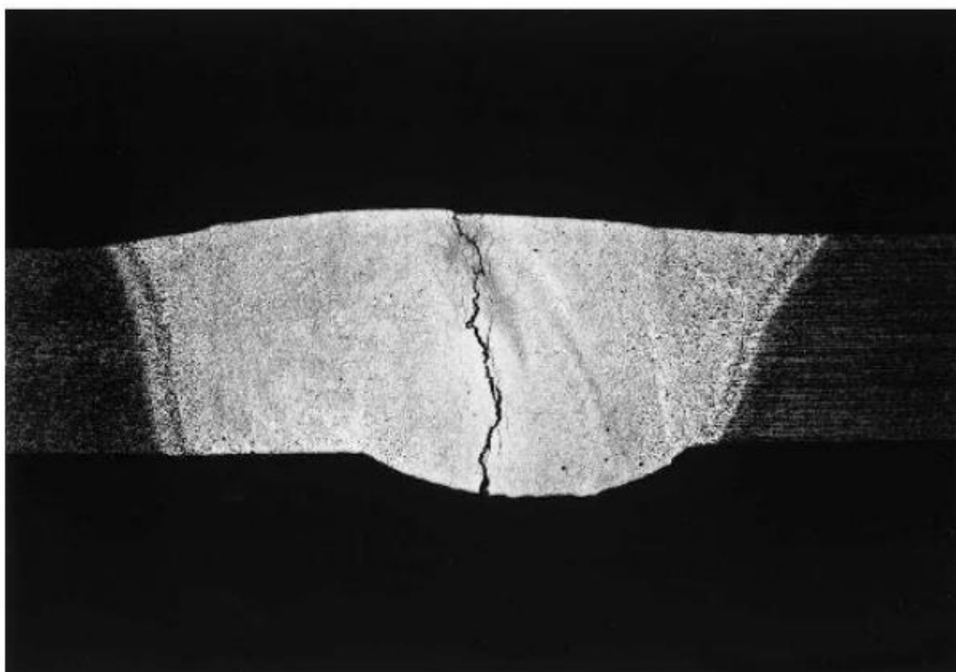
Slika 2. Prikaz tople pukotine nastale tijekom zavarivanja aluminija[5]
