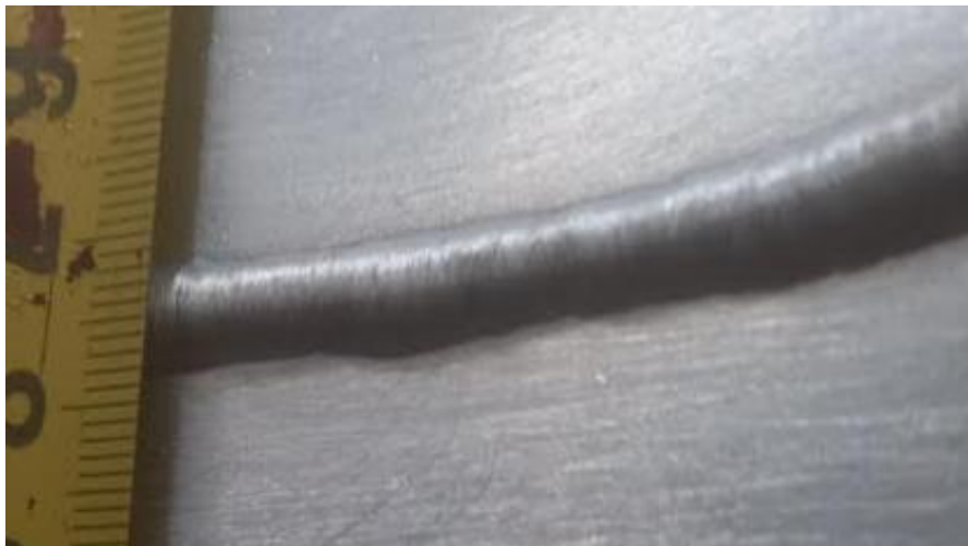
Slika 24. Prikaz korijena zavara zavarenog sa skošenjem na unutarnjem rubu cijevi
