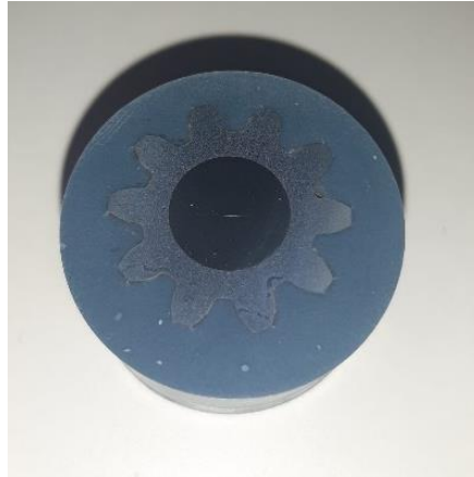
Slika 39. Izrezani uzorak pužnog vijka (na vratilu) u polimeru
