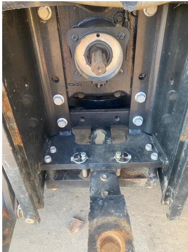
Slika 2. Izlazni priključak za radno vratilo
