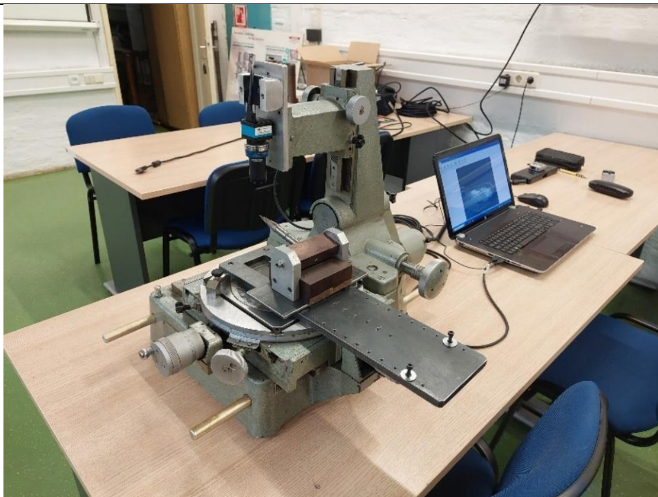
Slika 33 Postav za snemanje istrošenosti alata
