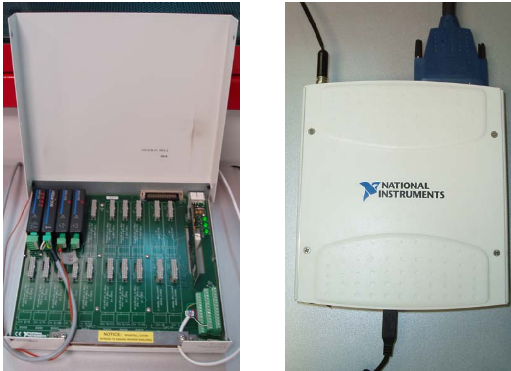
Slika 7.2. Kućište NI SC 2345 i A/D pretvarač NI USB 6251
