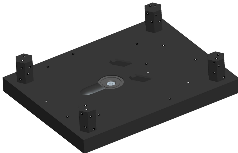
Slika 3.11: Stezna naprava sa nekodiranim referentnim točkama
