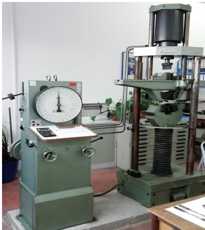
Slika 52. Kidalica 30 TUZ 757 za mjerenje vlačne čvrstoće
