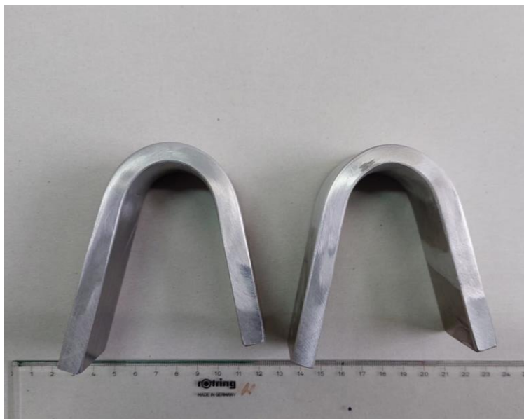
Slika 56. Poprečni presjek zavarenog spoja nakon savijanja
