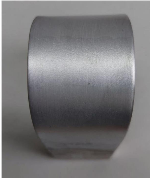
Slika 55. Prikaz zavarenog spoja nakon savijanja
