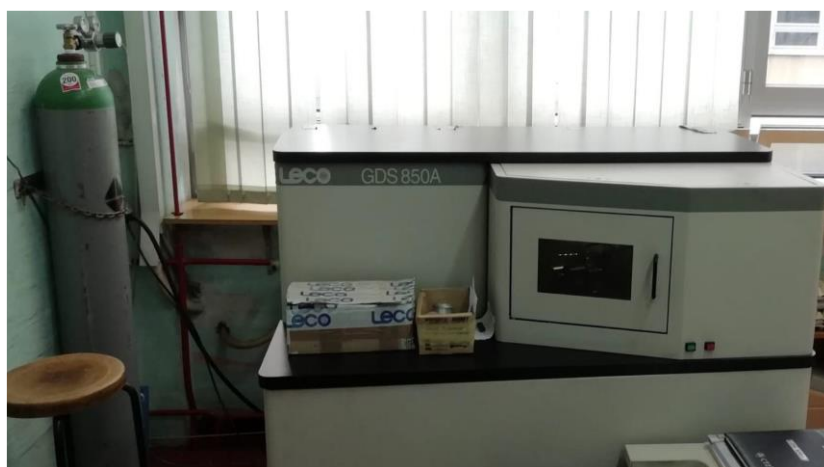
Slika 26. Prikaz spektrometra LECO GDS 850A za ispitivanje kemijskog sastava uzorka
