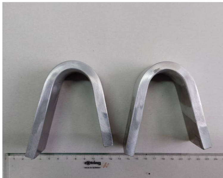
Slika 56. Poprečni presjek zavarenog spoja nakon savijanja
