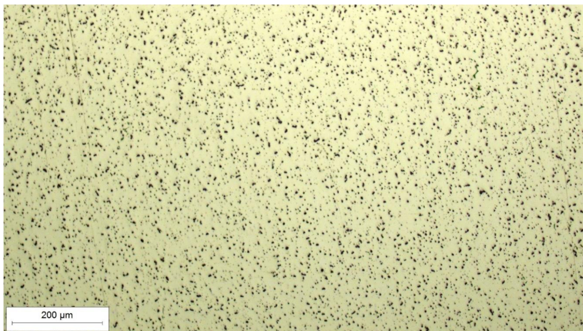
Slika 35. Mikrostruktura u sredini metala zavara u poliranom stanju, snimljena pri povećanju od 100×
