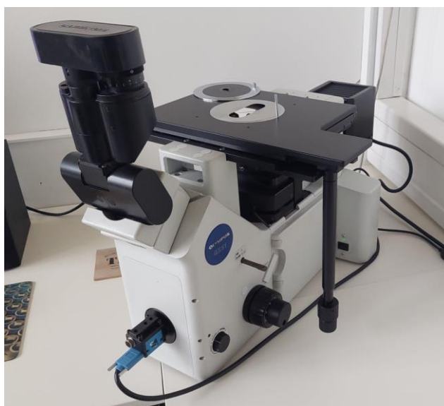
Slika 31. Svjetlosni mikroskop za analizu mikrostrukture
