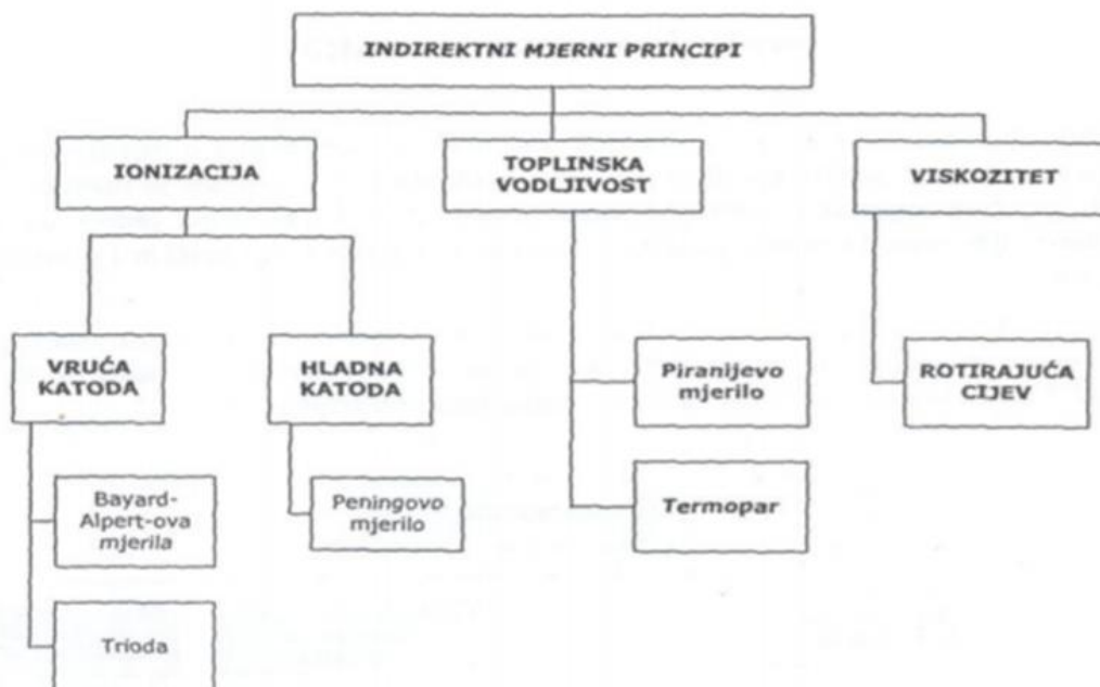
Slika 2. Indirektne metode mjerenja tlaka
