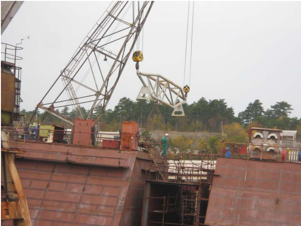
Slika 31 Rešetkasti nosač za prihvat i manipulaciju sekcija kod rada dizalica u tandemu
