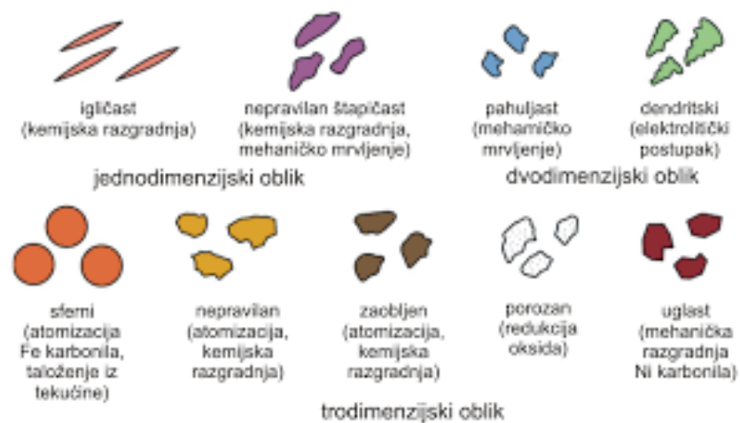
Slika 5. Oblik čestica praha i metode njihovog dobivanja [1]
