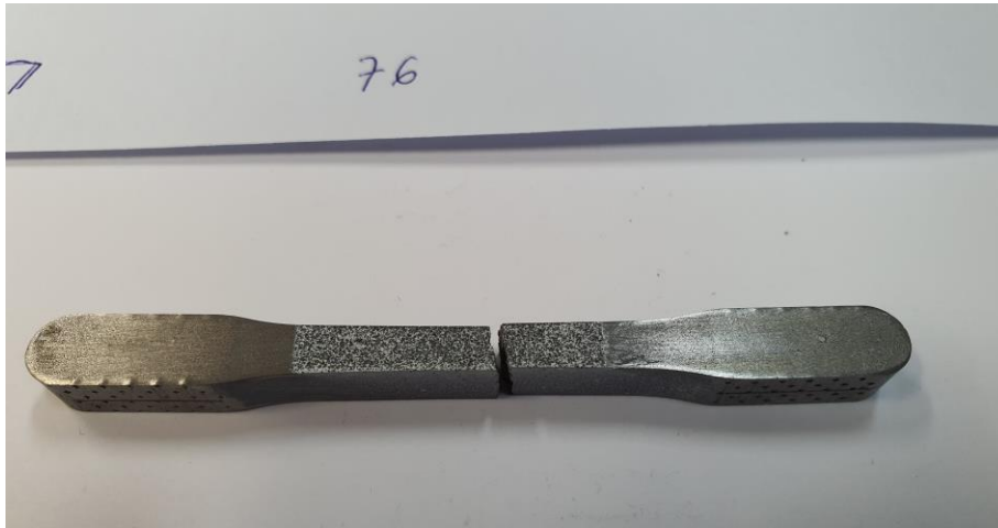
Slika 51. Lom epruvete kod eksperimentalnog ispitivanja
