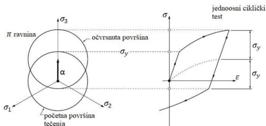
Slika 6.8. Prikaz kinematičkog očvršćenja [16]
