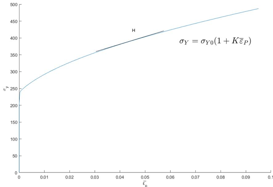
**Slika 8.2. Zakon očvršćenja prema modificiranom Swiftovom zakonu**
