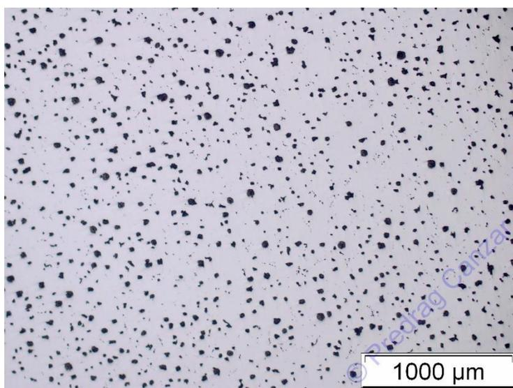
Slika 7.1. Primjer mikrostrukture Inmould nodularnog lijeva [4]
