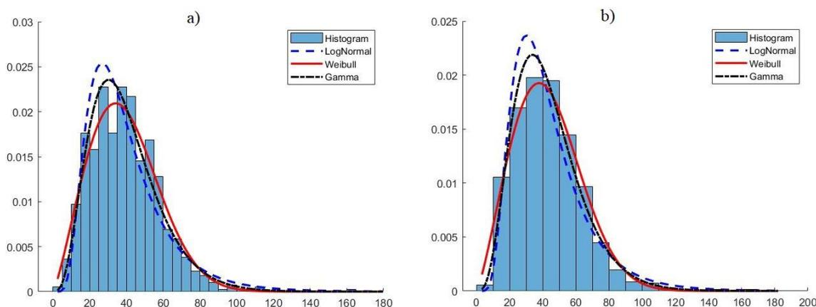
**Slika 7.4. a) Raspodjela najmanje udaljenosti nodula za Inmould način lijevanja, b) raspodjela najmanje udaljenosti nodula za Tundish način lijevanja**
