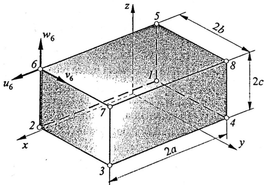
Slika 4.1. Osnovni prizmatični element s 24 stupnja slobode [12]
