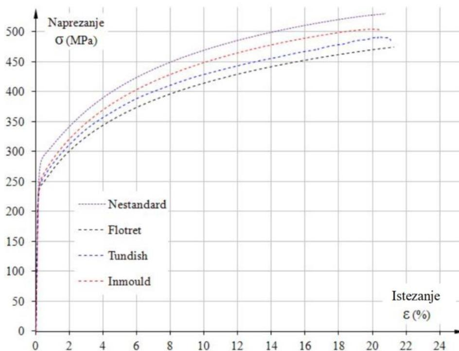
Slika 2.3. Dijagram stvarno naprezanje – deformacija [4]
